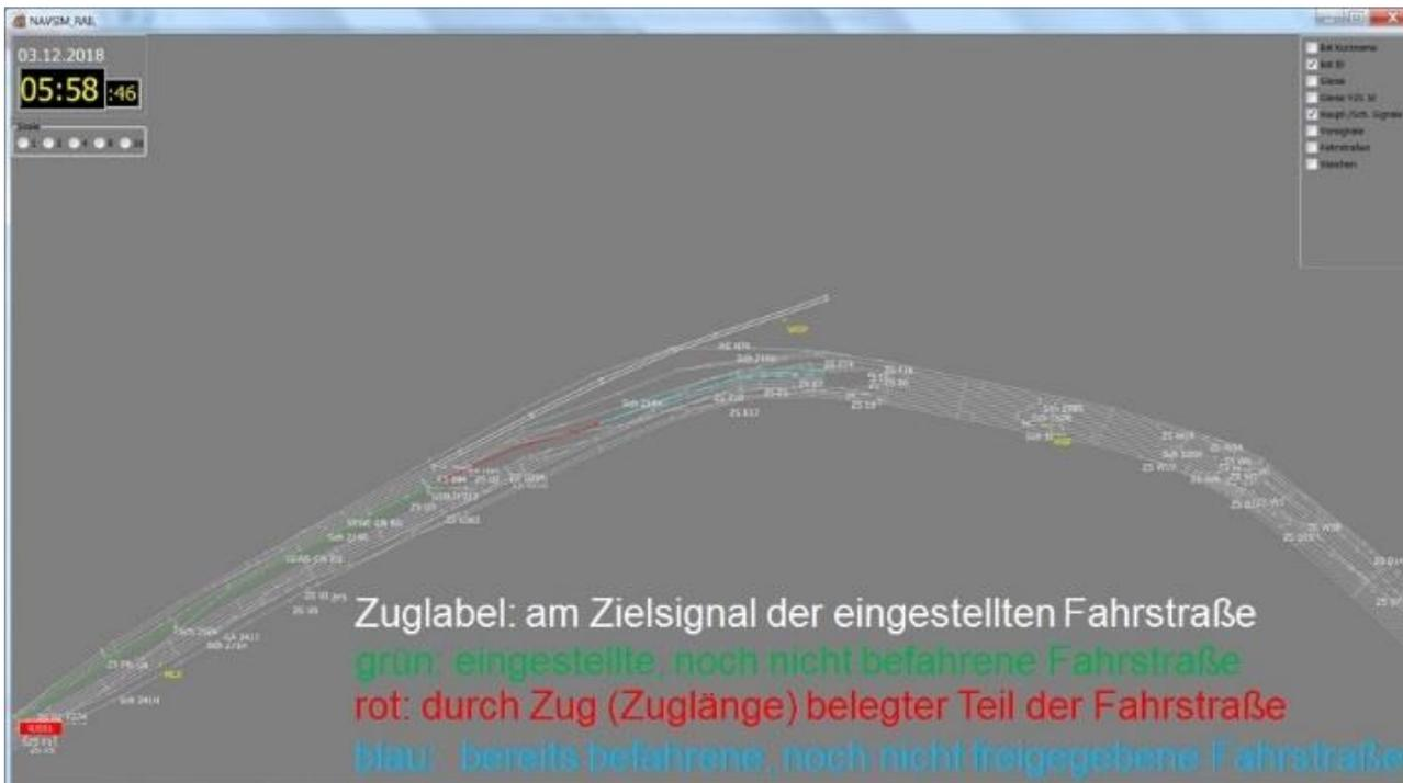
Abbildung 26: Wien Hauptbahnhof (Wbf): Beispiel eines Bahnhofsgleises – Implementierung mit Geo-Koordinaten; Darstellung der eingestellten und der bereits zurückgelegten Fahrstraße sowie die aktuelle Belegung durch die Zugfahrt; Visualisierung: NAVSIM-RAIL (Dispo-SIM)
