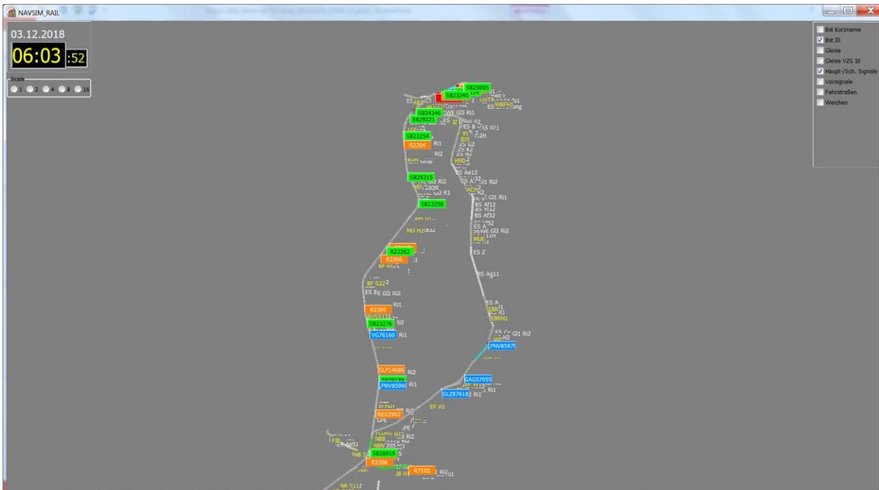
Abbildung 43: Beispiel für eine Verifizierung durch Simulation – Regelfahrplan; Darstellung der Situation zw. Wien Hauptbahnhof (Wbf) und Wr. Neustadt (Nb) (Bild:NAVSIM-RAIL)
