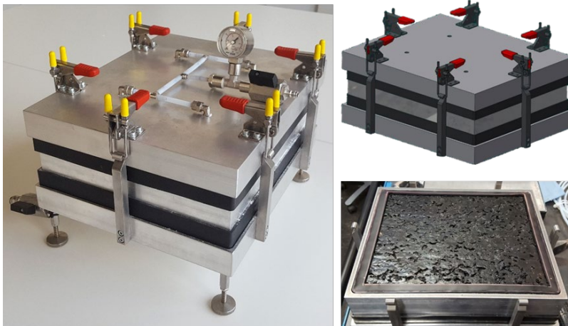
ABB 1. Die neu entwickelte Alterungszelle auf Grundlage des Viennese Aging Procedure (VAPro)
