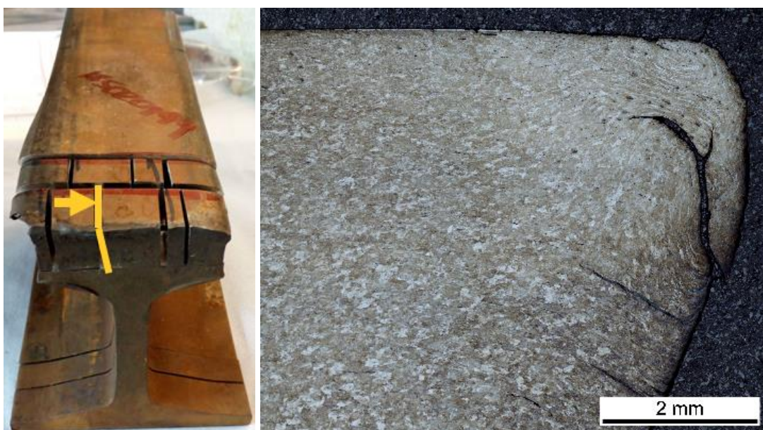
Abb. 4.1: Ausgebauter, verschlissener Schienenstoß: Makrobild (links), Gefügebild der verformten Zone (rechts).
