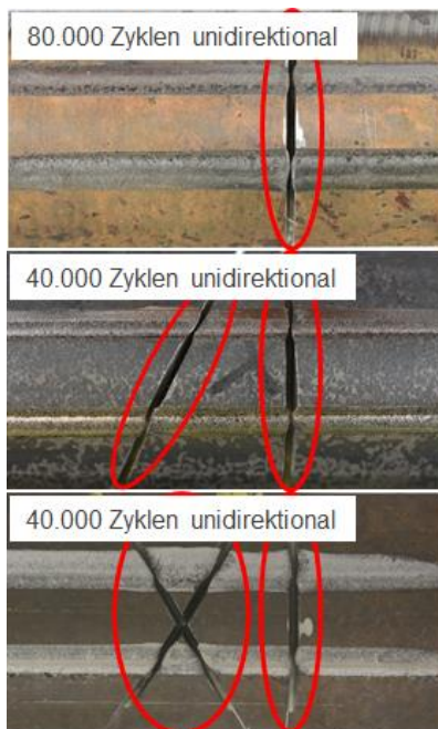
Abb. 4.23: Charakterisierung unterschiedlicher Schienenstoßsysteme: Draufsicht der Verschleißspur am Lichtmikroskop (links), Auswertung der Verformungsflächen bei unterschiedlichen Zyklen und Systemen (rechts).
