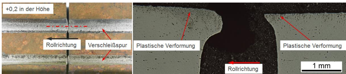
Abb. 4.24: Schienenenden nach Versuch am Modellteststand mit einem Höhenversatz von 0,2 mm; links: Übersichtbild; rechts: Schliffbild.
