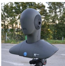
ABB 2. Beispielhafter untersuchter Bewuchsstreifen und eingesetzter binauraler Kunstkopf für messtechnische und psychoakustische Untersuchungen.
