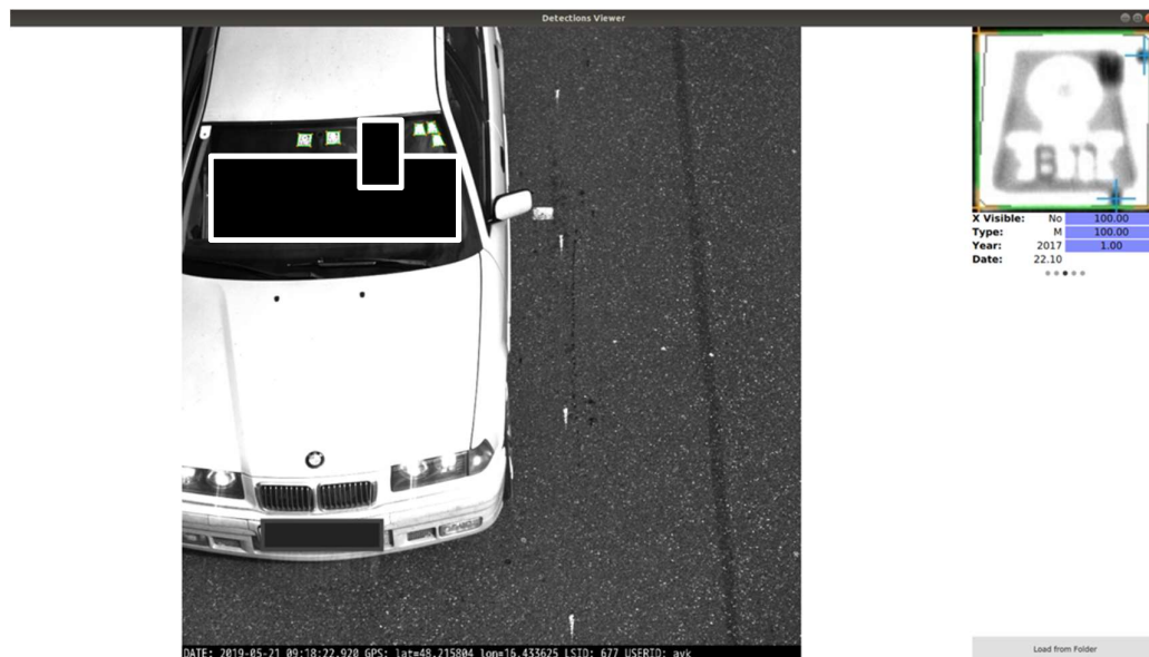
Abbildung 8: Screenshot des VMI Prototyps. Alle detektierten Vignetten werden angezeigt, dazu die Detektionsergebnisse und Konfidenzen der einzelnen Erkennungs-Module.
