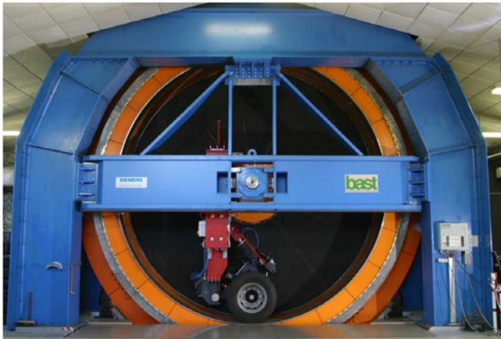
Abbildung 14: Der Prüfstand Fahrzeug/Fahrbahn der BASt [31]
