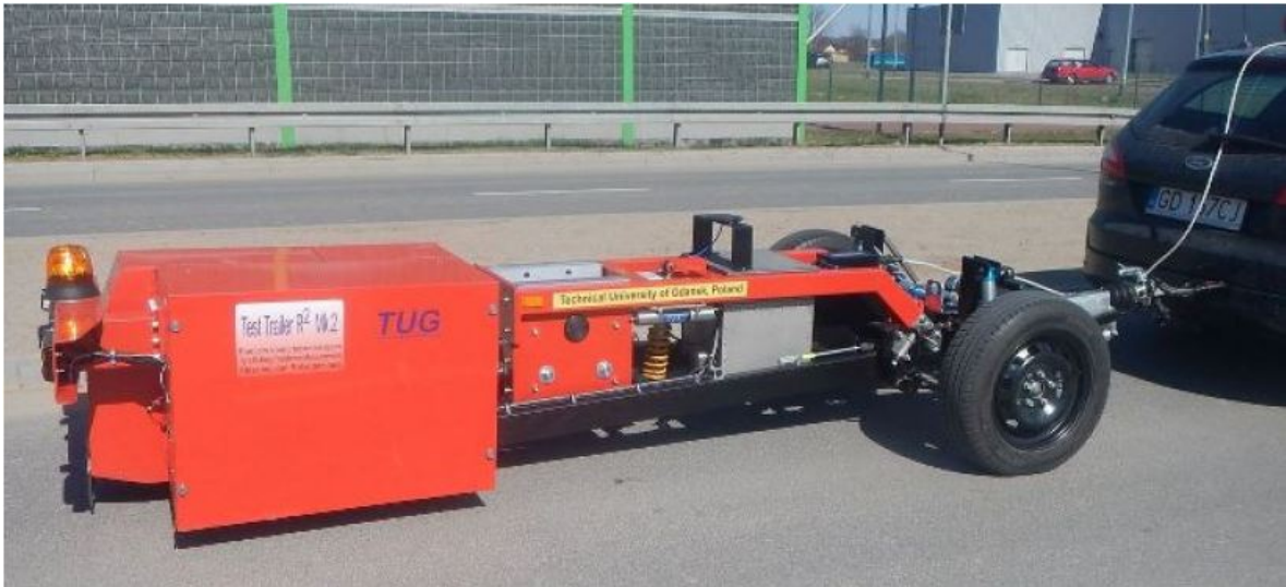
Abbildung 20: TUG-Anhänger für Rollwiderstandsmessungen [7]
