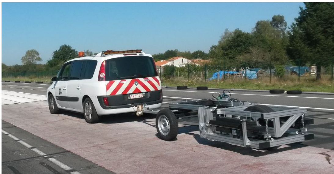
Abbildung 23: BRRC-Anhänger für Rollwiderstandsmessungen (Kraftprinzip), (Quelle: ROSANNE)
