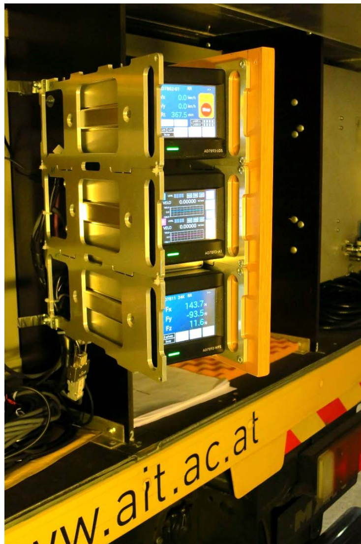
Abbildung 41: Aufbau der Messrechner und Logging-Rechner für Kraftmessfelge und Laser Ground System auf schwenkbarem Panel im Schaltschrank am Fahrzeugheck.
