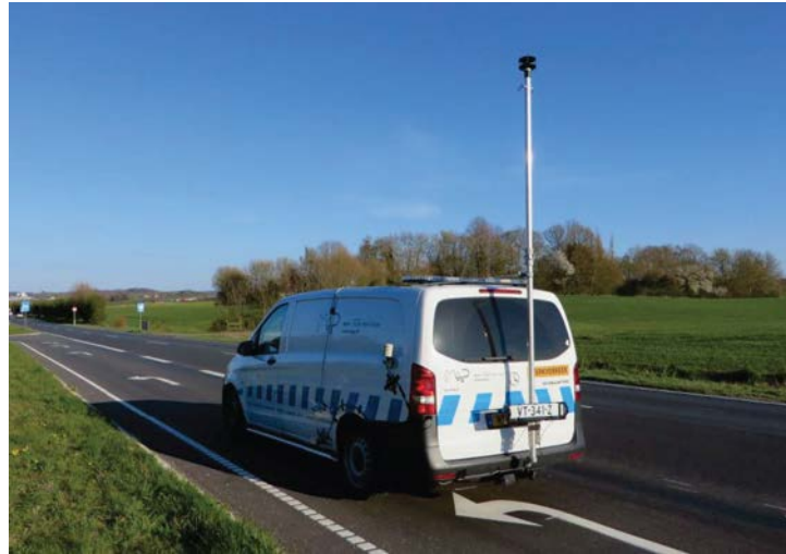
Abbildung 30: Kraftstoffverbrauchsmessung mit Messsystem der Firma M+P [16]
