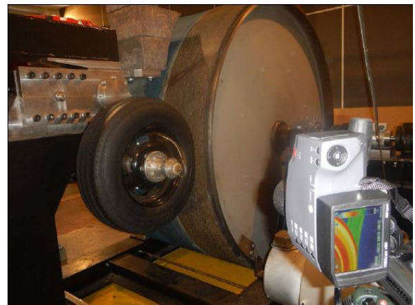
Abbildung 13: Labortrommel in TU Gdansk mit einem Trommeldurchmesser von 2 m [15]
