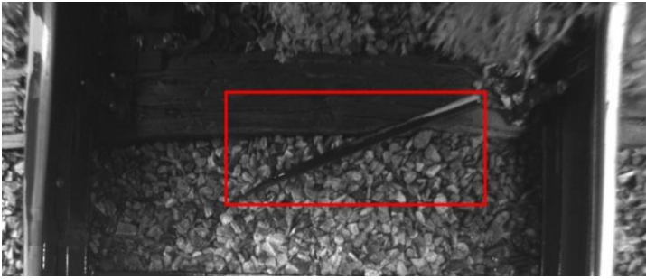
ABB 2. Sensorevaluierung: Fremdkörper am Gleisbett
