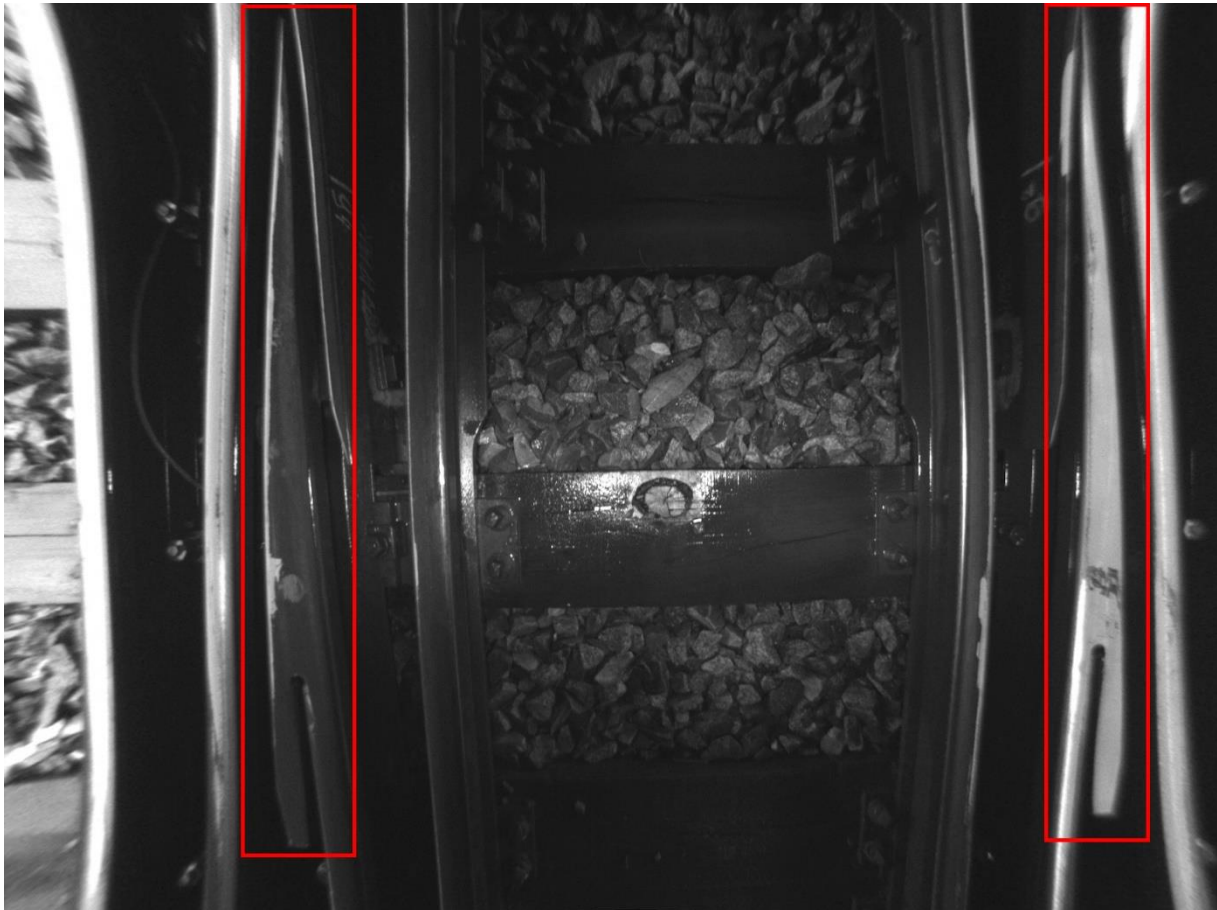
Abb. 42: entzerrtes Bild von Weiche mit erkannten Weichenherzen
