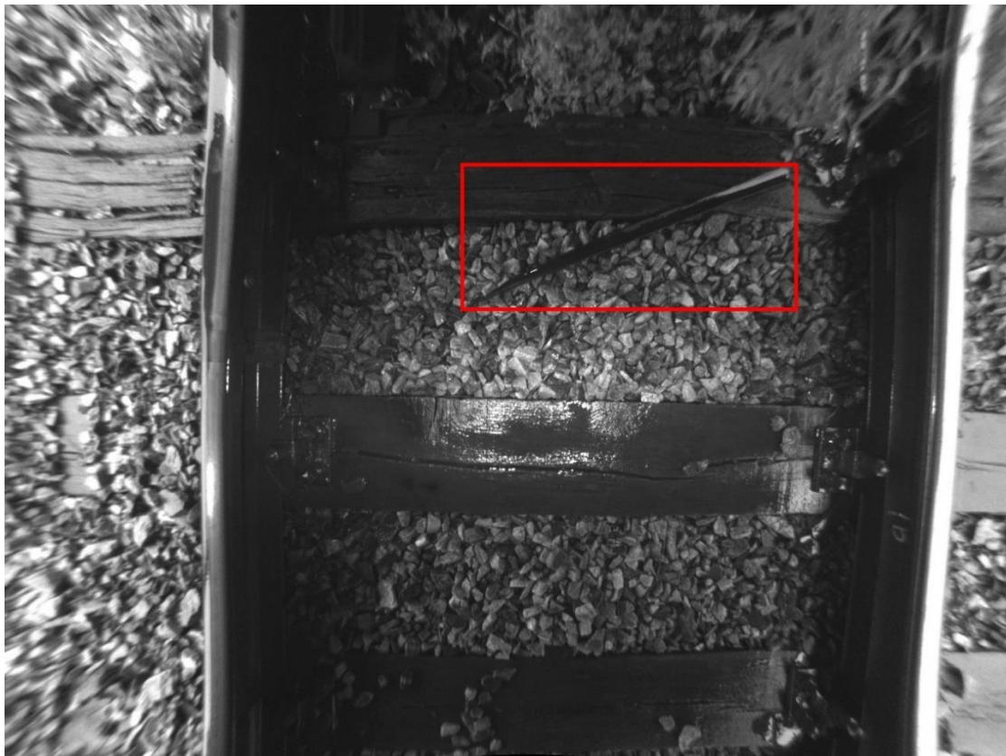
Abb. 51: Fremdkörper am Gleis, entzerrtes Bild mit erkanntem Objekt
