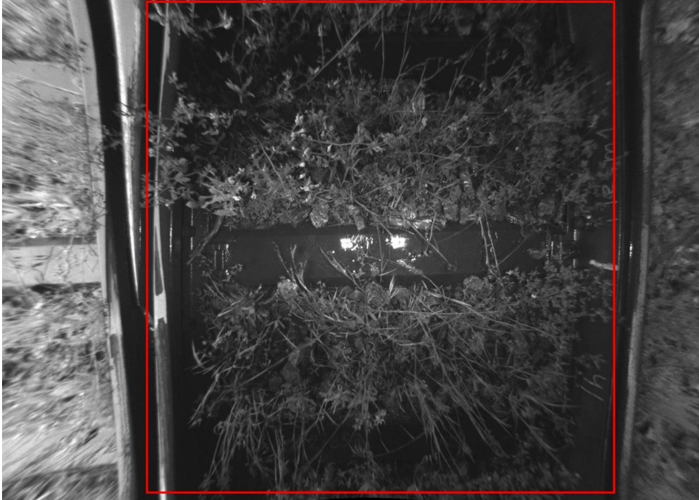
Abb. 45: Bewuchs am Gleiskörper, entzerrtes Bild mit erkanntem Bewuchs
