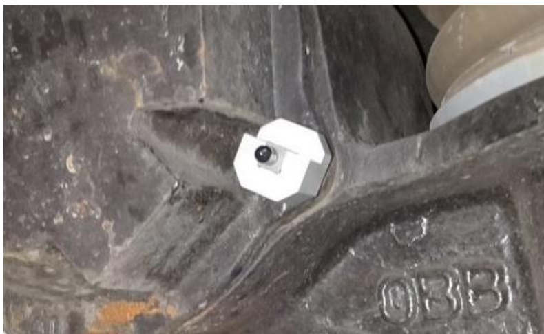
Abb. 24: Beschleunigungssensor an der Achse
