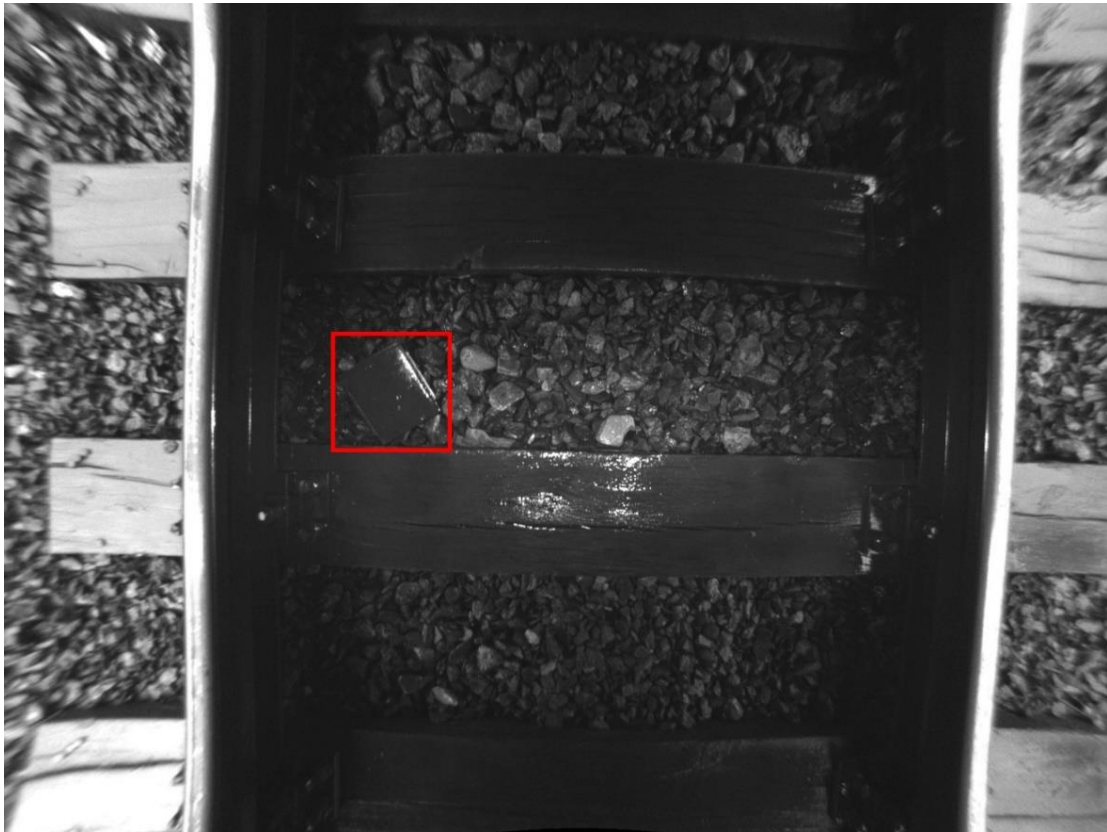
Abb. 50: Fremdkörper am Gleis, entzerrtes Bild mit erkanntem Objekt
