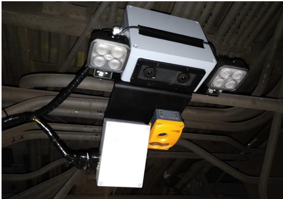
Abb. 23: Kamerasystem, LIDAR-Sensor und RADAR - Zug Unterseite
