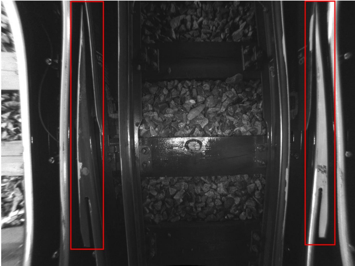
Abb. 29: entzerrtes Bild von Weiche mit erkannten Weichenherzen
