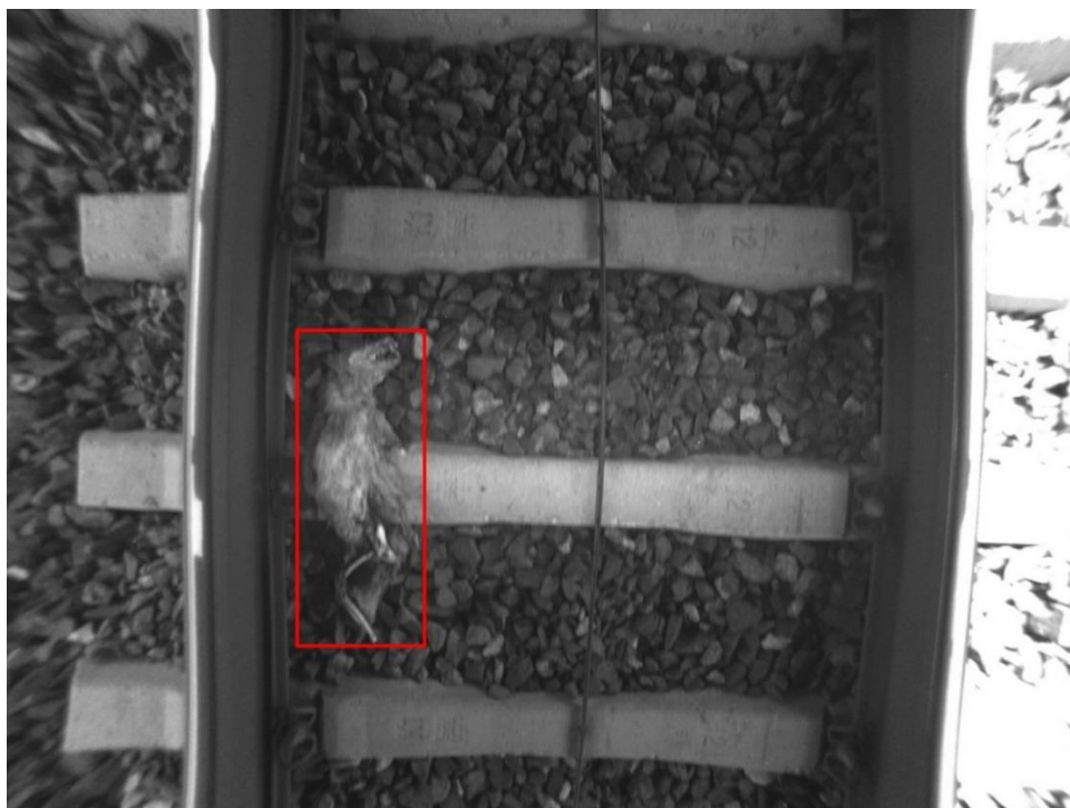
Abb. 47: Totes Tier, entzerrtes Bild mit erkanntem Objekt
