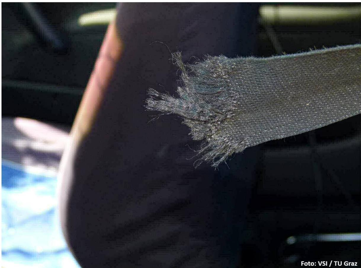
Abbildung 55: Durchtrennter fahrerseitiger Sicherheitsgurt
