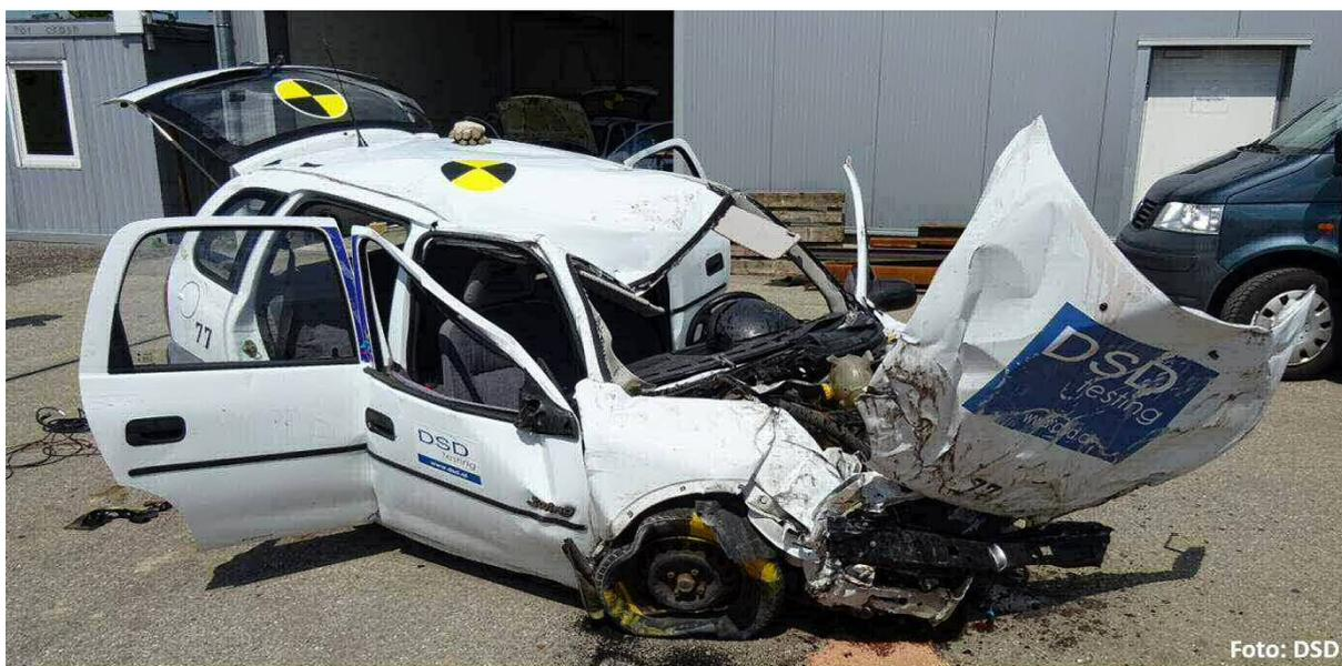
Abbildung 14: Beschädigungen am Fahrzeug "BMV17001"
