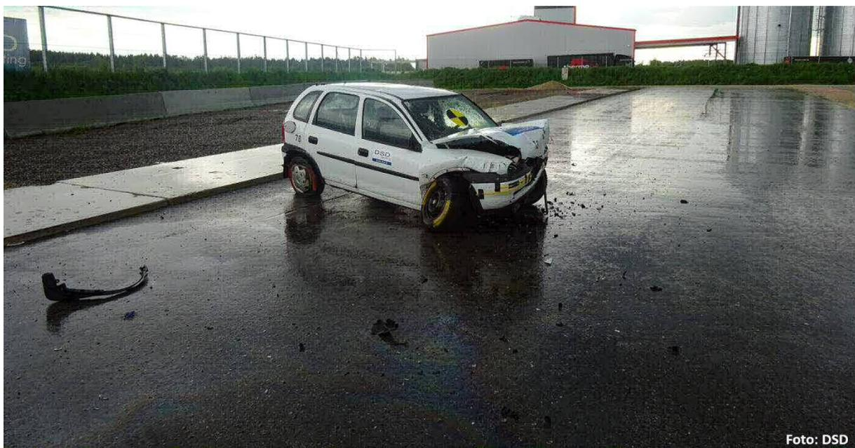
Abbildung 26: Fahrzeug in Endlage "BMV17002"
