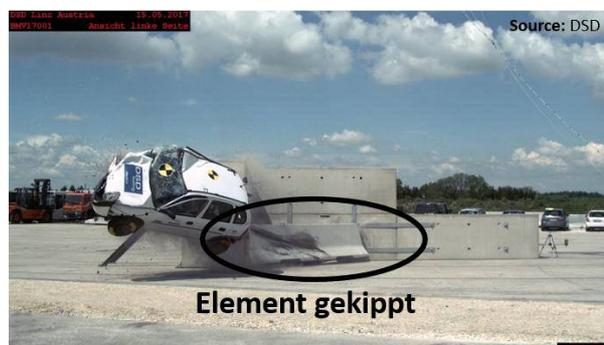
Abbildung 26: Kippen einer Absicherungsmaßnahme zufolge einer Kollision
