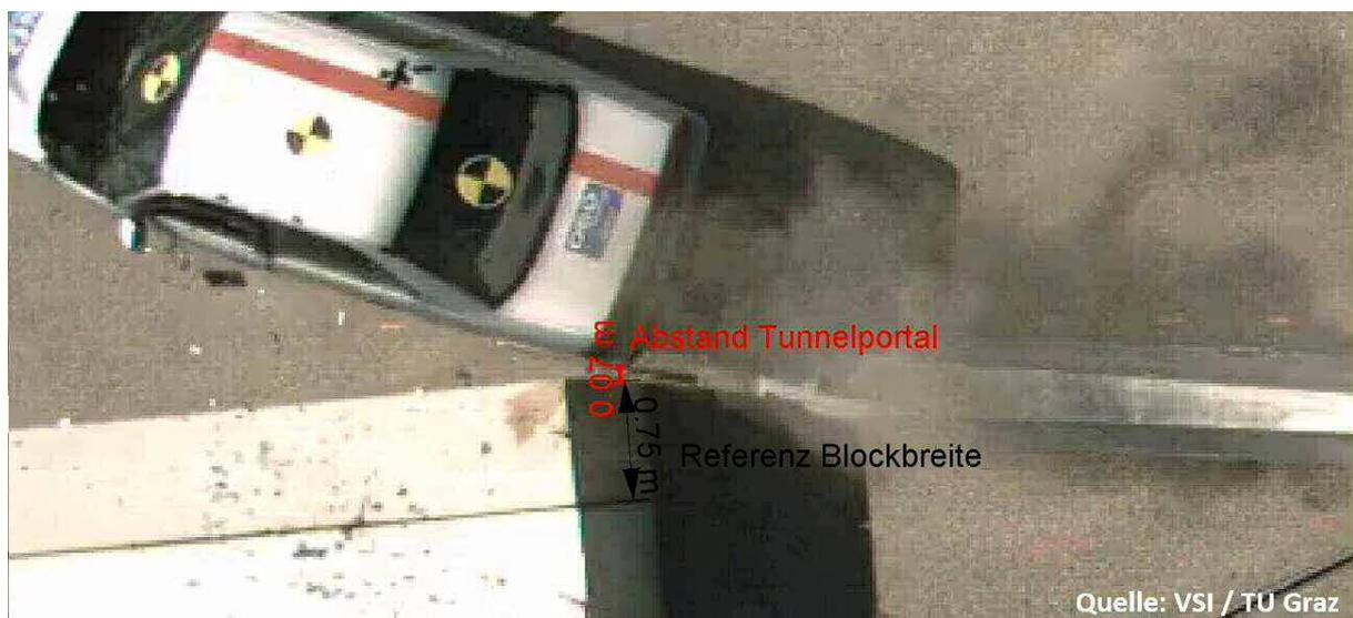
Abbildung 64: Distanz zwischen Fahrzeug und Tunnelportal
