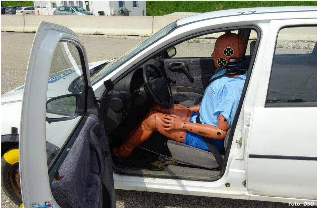
Abbildung 2: Positionierung des Crashtest-Dummies im Fahrzeug
