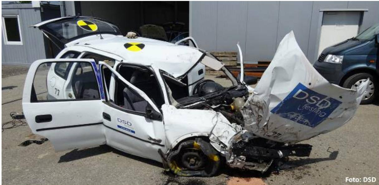
Abbildung 20: Massive Deformation der Fahrgastzelle nach einem Anprall
