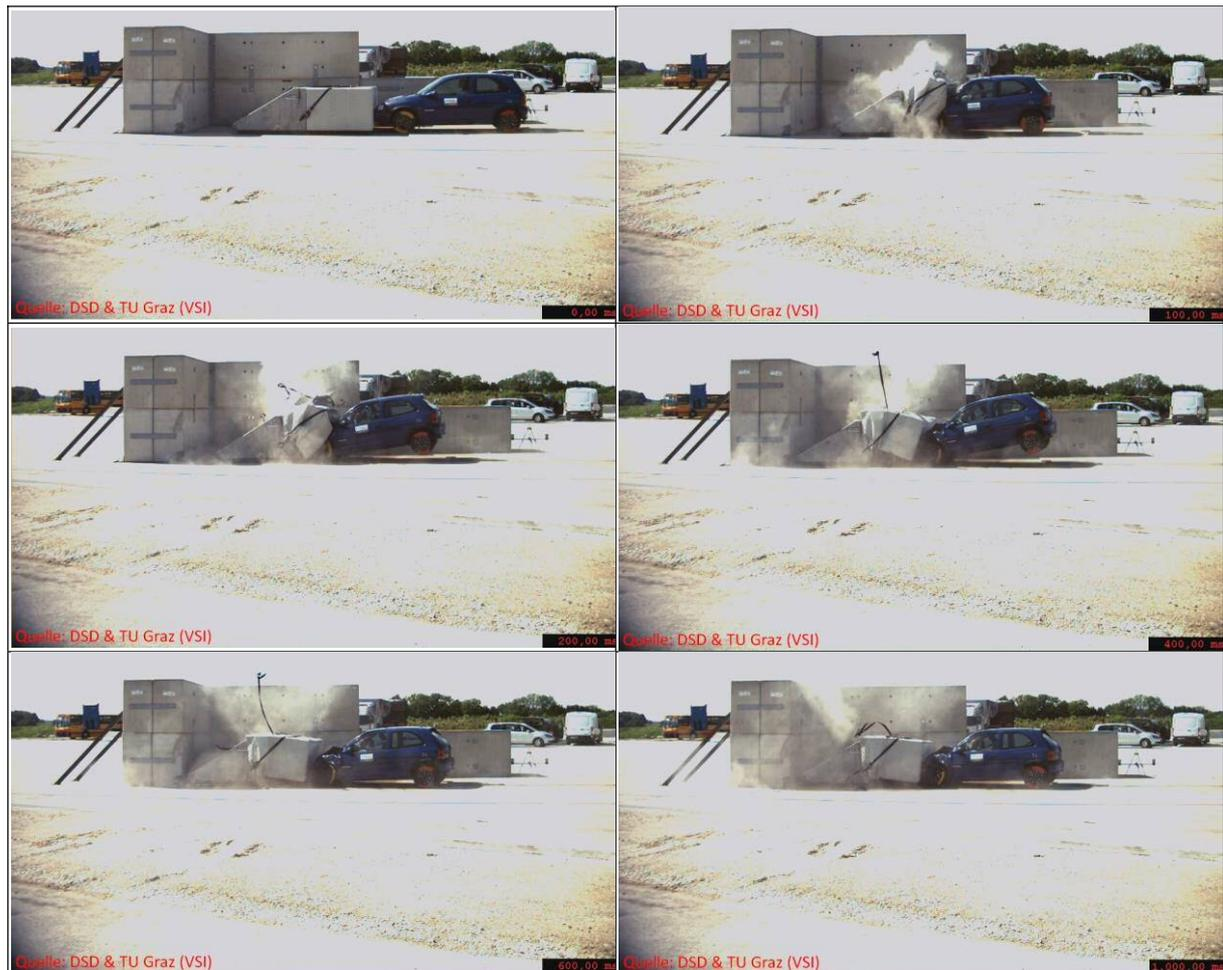
Abbildung 37: Fahrzeugkinematik beim Anprall an den Anpralldämpfer „Alpina F1-50“
