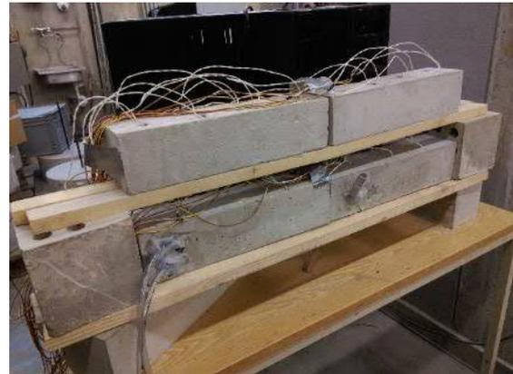
Abbildung 66: Grundriss und Ansicht des hergestellten Testkörpers Nr. 4 mit der Lage der Bohrungen und Temperatursensoren und Messaufbau (rechts unten)
