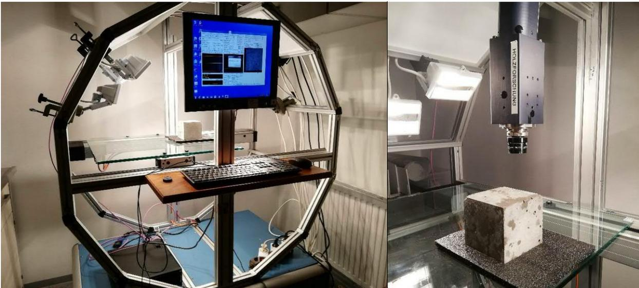
Abbildung 79: Aufbau Hyperspektralkamera vom Institut für Holzforschung
