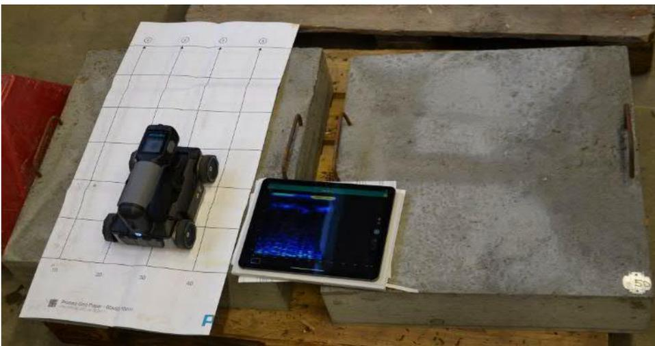
Abbildung 76: GPR Live mit Rastervorlage zur Aufnahme der Betonplatten
