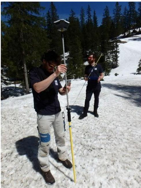
Abbildung 123: Händische Kontrollmessung der Schneemächtigkeit mittels Messsonden
