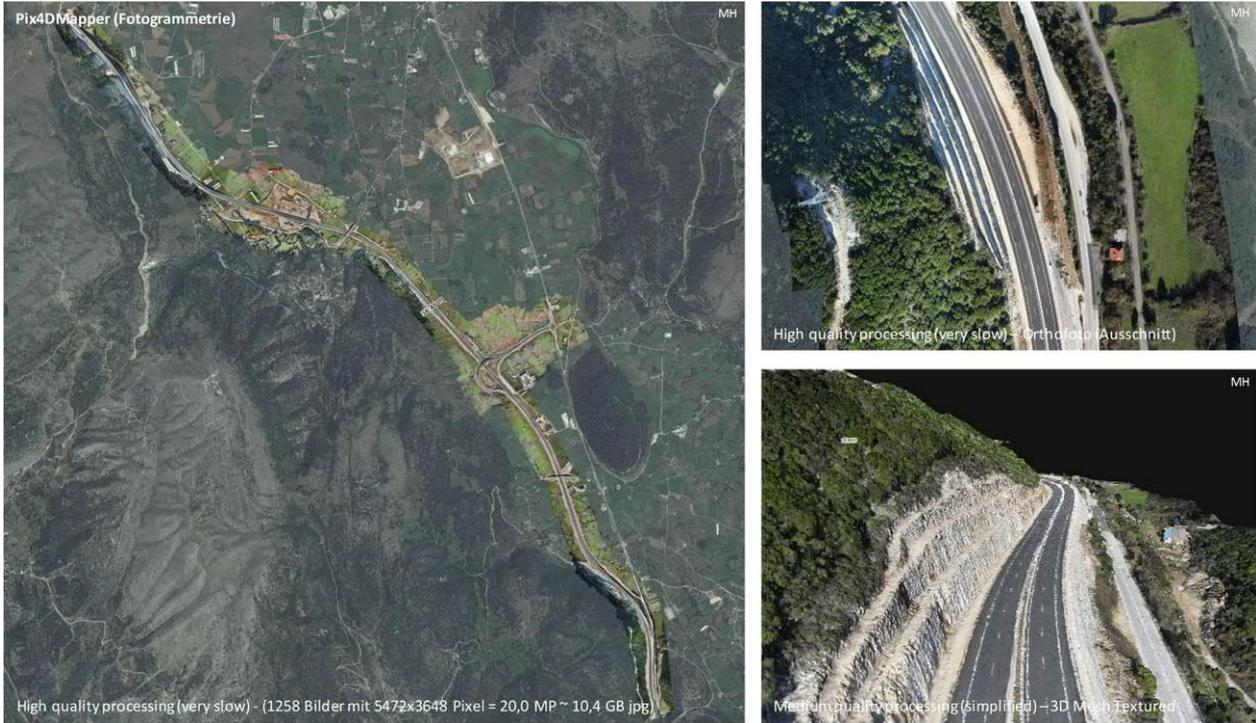
Abbildung 38: Pix4DModeller (Ansicht Big Data - Überblick 36 km Autobahn - Dezimeter)
