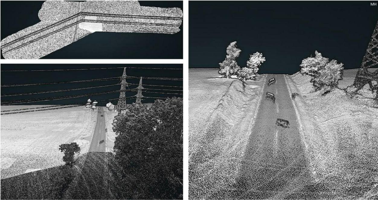
Abbildung 28: Airborne – Laserscans liefern Punktwolken mit mittlerer Auflösung und sehr hoher Lagegenauigkeit – die Datenverarbeitung und Bereinigung erfolgt mit Herstellersoftware (z.B. RIEGL)
