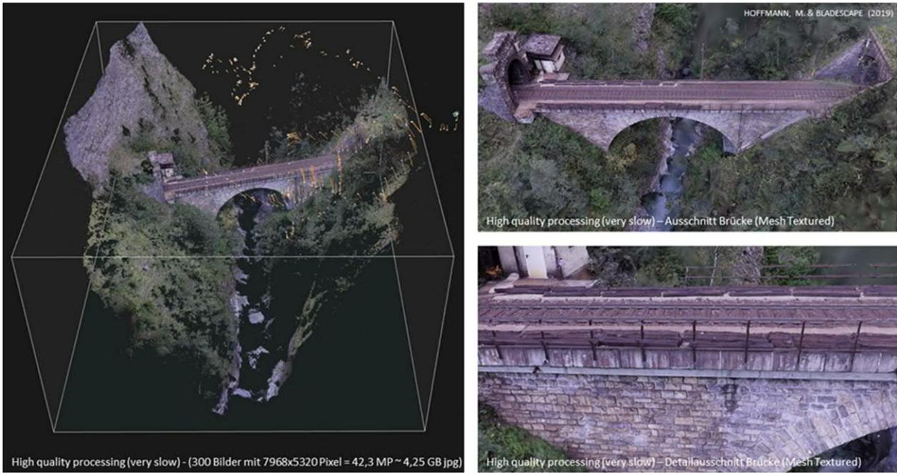
Abbildung 96: Schutzverbauung Klammstein – 3D - Modellüberblick und Ausschnitt Brücke
