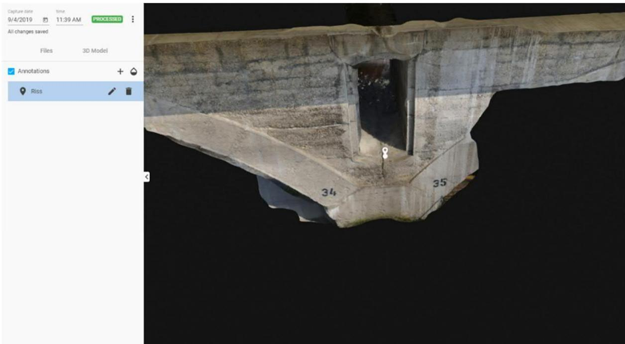
Abbildung 39: Pix4DModeller (B2 Italienschleife - Orthoplane und Inspektion Bogen 34) inklusive einer Annotation aus RISKMON (Ansicht: Mesh - Submillimeter)
