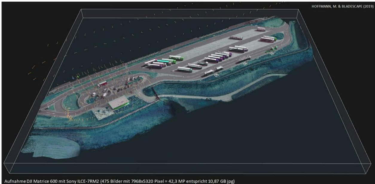
Abbildung 175: S1 Streckeninspektion Pöchlarn – 3D – Modell und Flugplan Rastplatz
