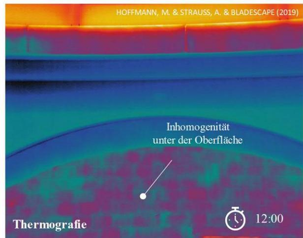
Abbildung 113: Italienschleife – Beispiel Auswertung Differenzaufnahme Thermografie
