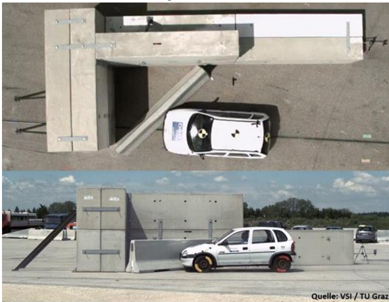
ABB 1. Anprall an das Betonleitwandelement
