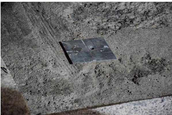
**Abbildung 90: durch den Bolzen des Höhenjustiersystems durchstanzte dünne Stahlplatte**
