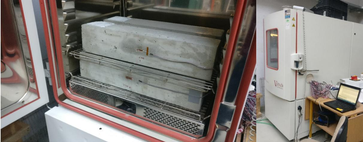
**Abbildung 153: Klimakammer mit Betonproben zur Bestimmung des Temperaturexpansionskoeffizienten**
