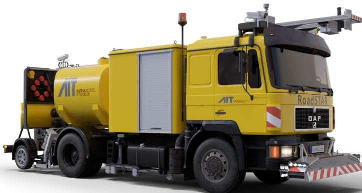
**Abbildung 140: Erfassung der Oberflächeneigenschaften und Geometrie mit dem Hochleistungsmessfahrzeug RoadSTAR.**
