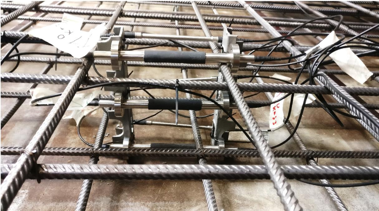
**Abbildung 149: Positionierte Sensoren (drei Dehnungs- sowie drei Temperatursensoren) unmittelbar vor dem Betonieren.**
