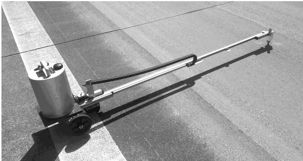
Abbildung 45: ELAlinear auf teilweise einem Grinding unterzogener Waschbetonoberfläche
