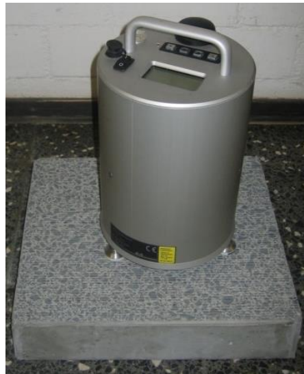
Abbildung 65: Für die Laboruntersuchungen verwendetes Texturmessgerät
