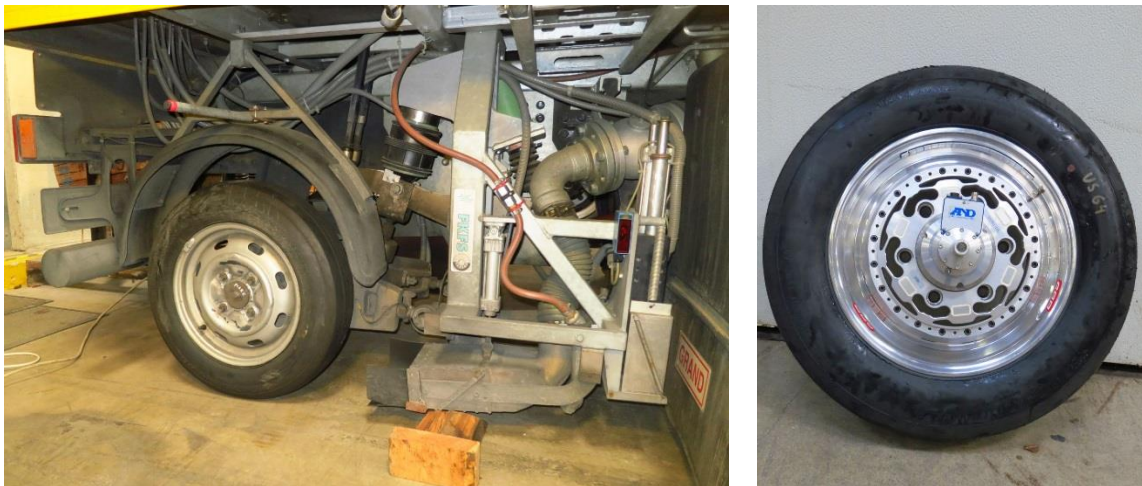
Abbildung 54: Griffigkeitsmesseinrichtung und Kraftmessfelge für Rollwiderstandsmessung
