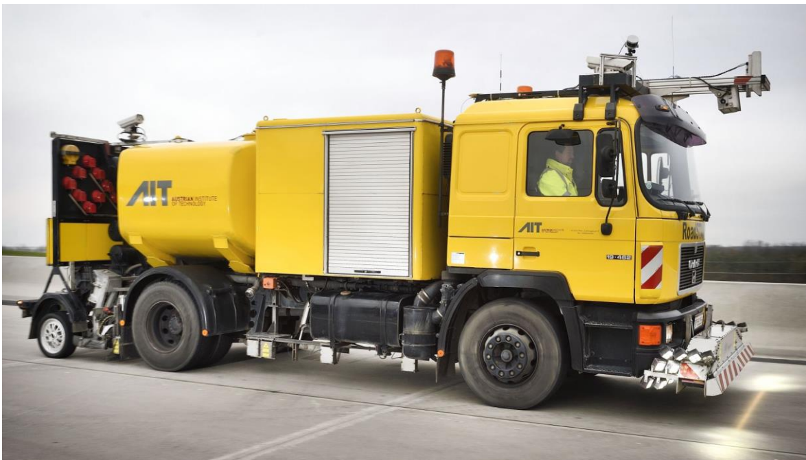
Abbildung 43: Messfahrzeug RoadSTAR zur Erfassung von Griffigkeit, Längs- und Querebenheit.
