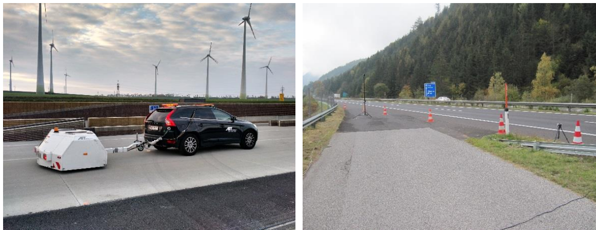
Abbildung 49: CPX-Messmethode (links), SPB-Messungen (rechts).
