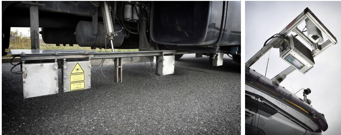
Abbildung 46: Längsebenheits-Messsystem (links), Querebenheits-Messsystem (rechts).
