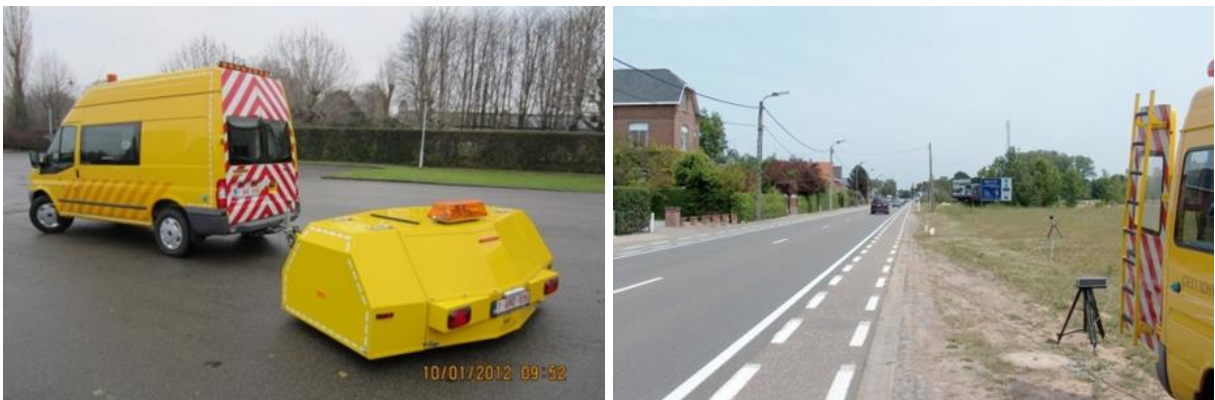
Abbildung 26: links: CPX-Anhänger, rechts: Statistische Vorbeifahrt-Methode (SPB)
