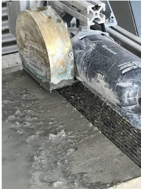
Abbildung 60: Herstellung der gegrindeten Oberfläche mittels Laborgrindingmaschine
