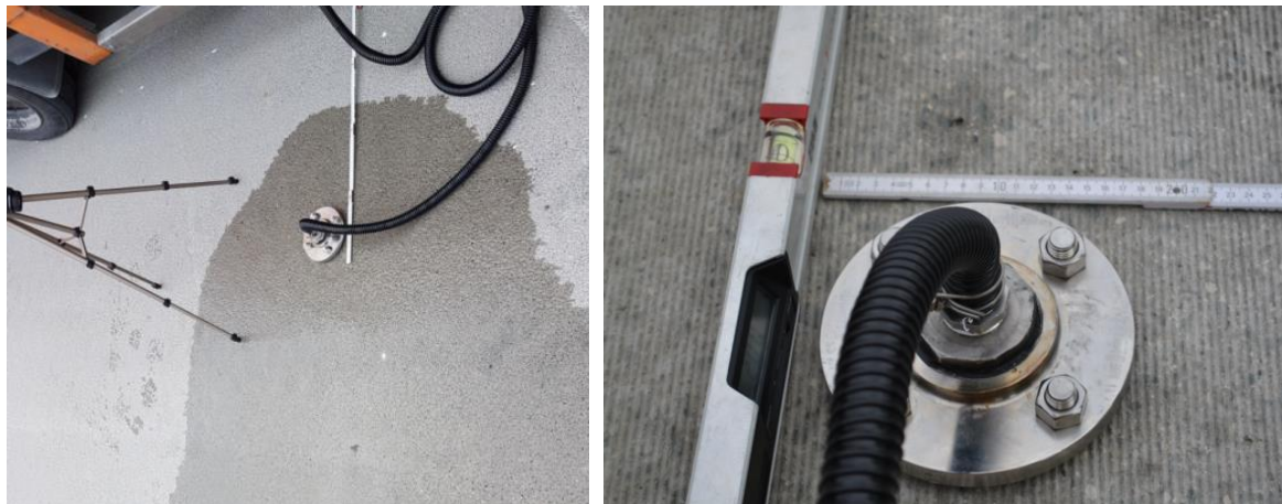
Abbildung 135: Durchführung von Ausflussversuchen auf Waschbeton- und Grinding-Oberflächen
