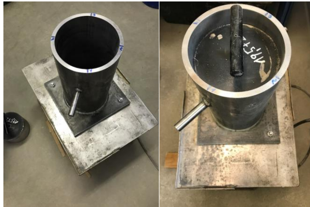
Abbildung 69: Experimentelle Bestimmung der Packungsdichte nach de Larrard
