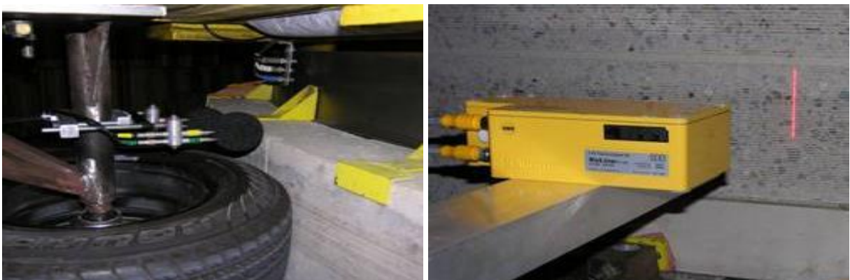
Abbildung 17: links: Messung der Reifen/Fahrbahngeräusche im Labor, [3], rechts: Lasermessung der Oberfläche im Labor, [3]
