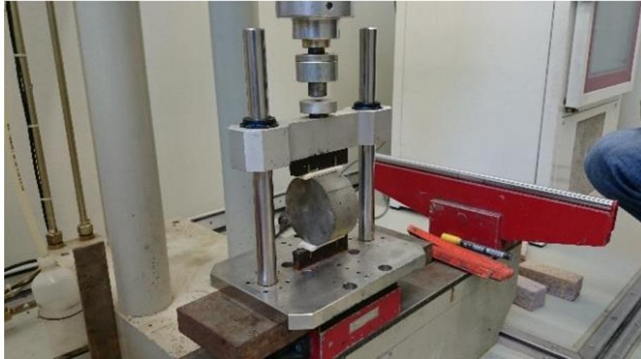
Abbildung 4-2: Statischer Spaltzugversuch
