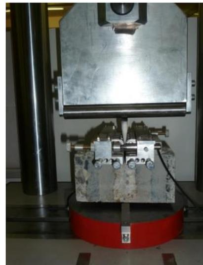
**Abbildung 4-25: Ermittlung der bruchmechanischen Kennwerte**
