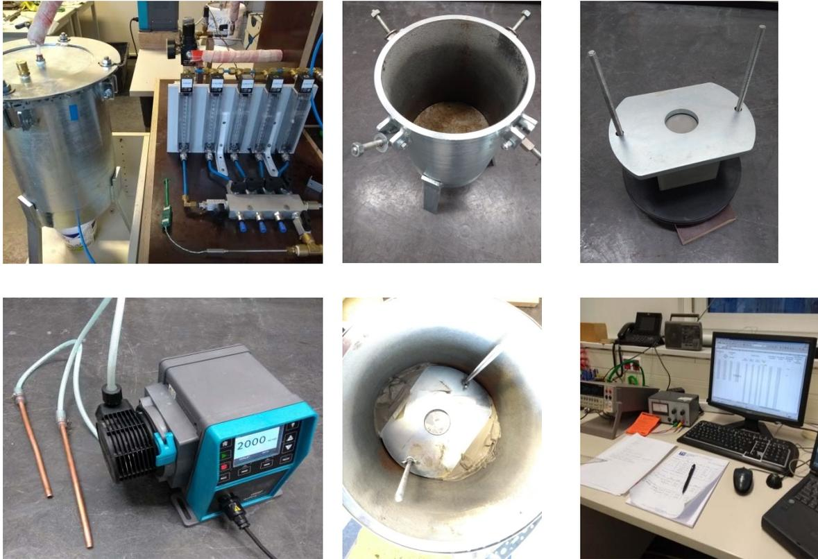
**Abbildung 5-6 Neu entwickelte Messmethode zur Messung der Luftpermeabilität**
