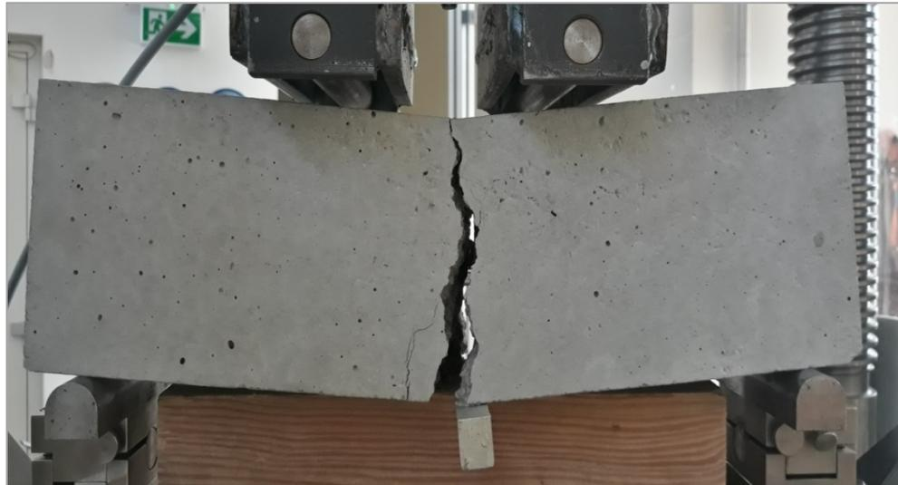
Abbildung 5-10 Vorderes Bruchbild der Probe P9
