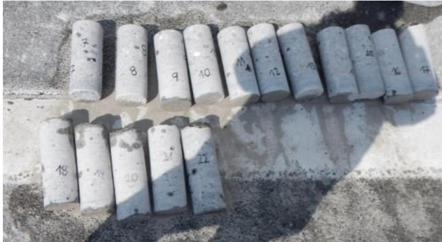
**Abbildung 3-11: entnommene Bohrkern**
