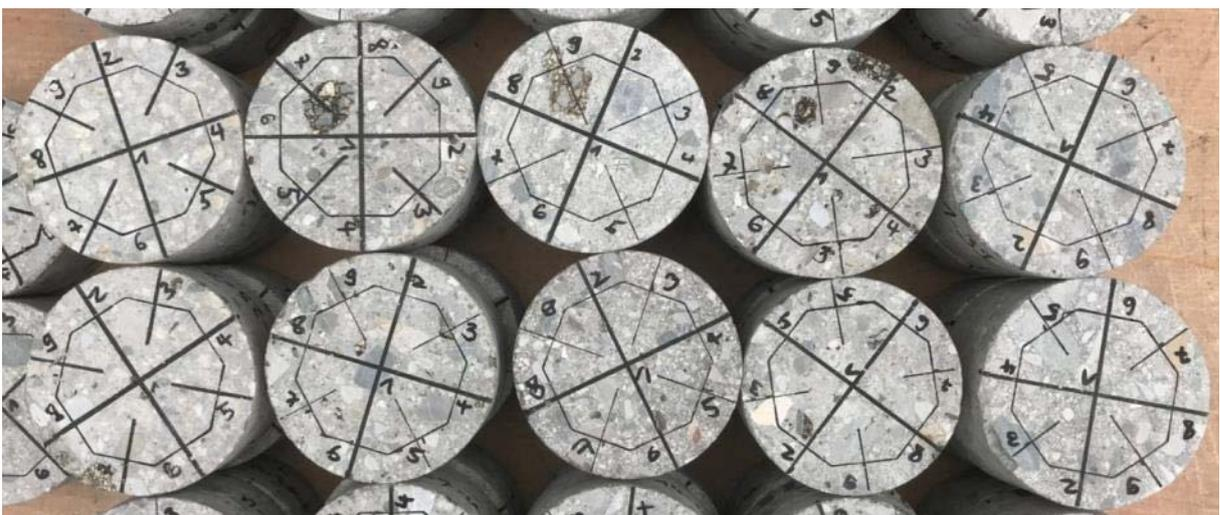
**Abbildung 4-33: Mit Messraster und Belastungsrichtungen versehene Bohrkernscheiben**
