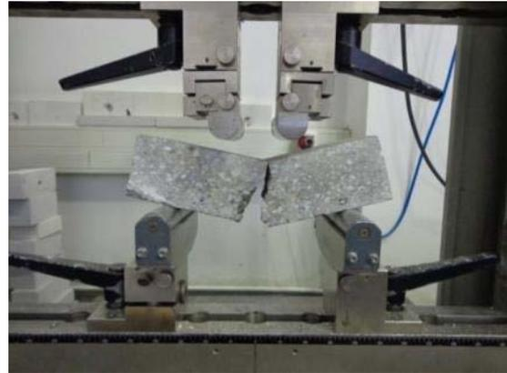
**Abbildung 4-13 Biegeversuch an den Bestandsproben**
