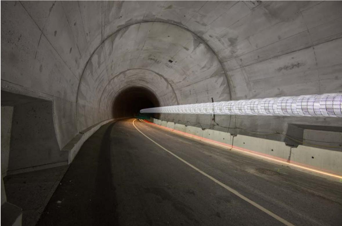
Abbildung 13: Dibat Hochgeschwindigkeits-Messsystem bei einer Testfahrt mit rd. 80 km/h im Tunnel, aufgenommen mit einer Langzeitbelichtung. Eine eigens konzipierte Blitztechnik beleuchtet gleichmäßig die Tunnellaibung. Die Aufnahme mit dem „endlosen“ Blitzband soll die Zukunftsvision einer schnellen, hochqualitativen Tunnelinspektion verdeutlichen.
