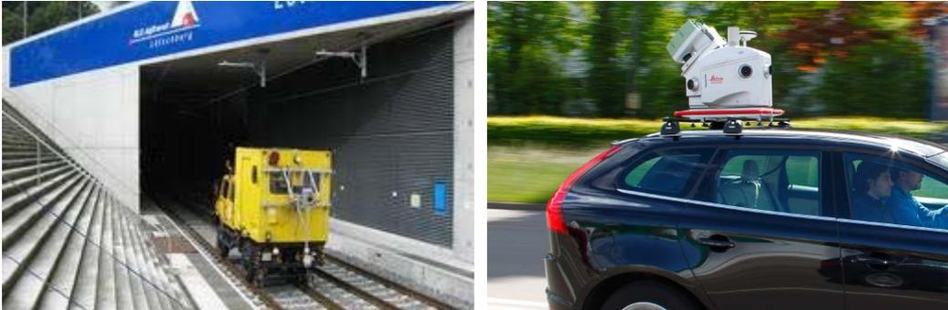
Abbildung 5: Links: Das SPACETEC TS3 auf einem Zweiwegefahrzeug montiert.
