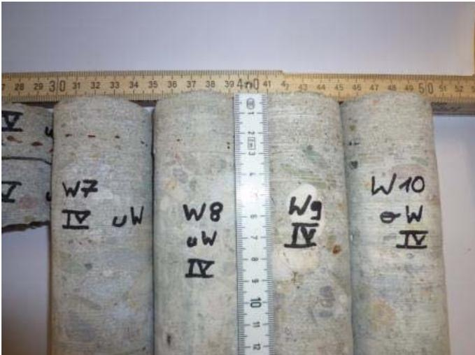
Abbildung 2: Stahlbeton-Bohrkerne [39]
