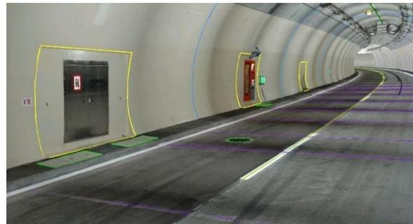
Abbildung 8: Fototexturiertes 3D-Modell eines Straßentunnels mit erfassten Objekten
