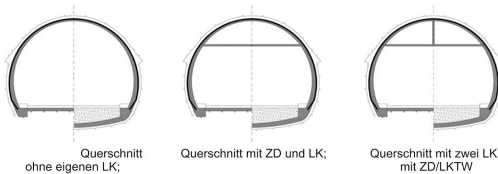
Abbildung 4: Tunnelquerschnitte gemäß [3]
