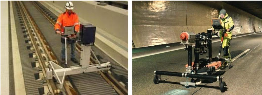
Abbildung 4: Links: Das hybride, kinematische System SPACETEC TS2 während eines Tunnelscans. Das Messsystem mit zwei Aufnahmekanälen scannt simultan Geometrie- und Foto-daten. Quelle: [www.spacotec.de](http://www.spacotec.de)
