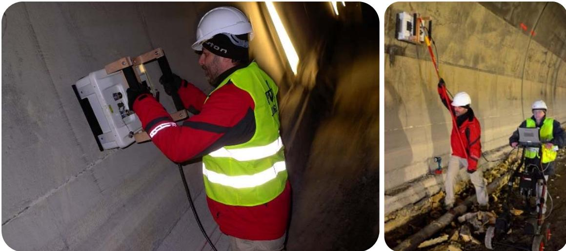
Abbildung 1: Umgebaute 200/600 MHz-Antennenkombination für geringe Messhöhen (links) sowie für Messhöhen bis 4m (rechts).
