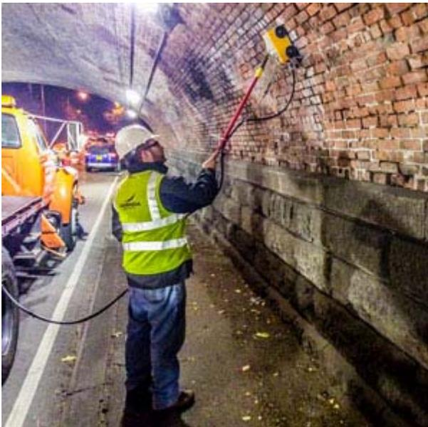
Abbildung 4: Boden-gekoppeltes Radar zur Messung der Tunnelwand [40]
