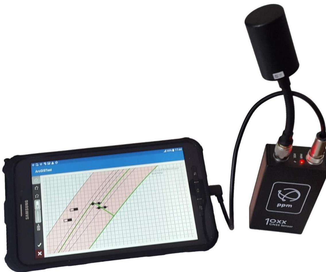
**Abbildung 6: SAWAS Demonstrator mit GNSS-Empfänger**
