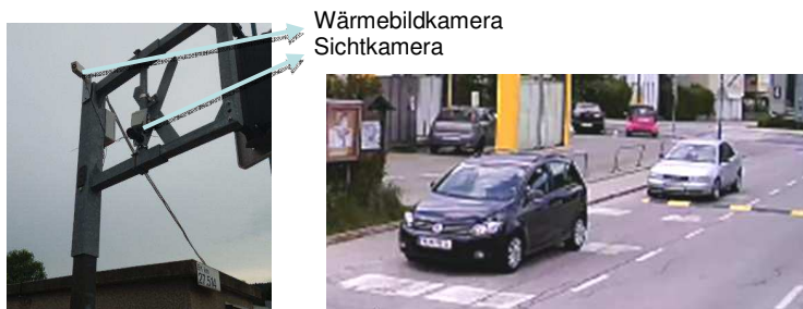
ABB 1. Sicht auf die verwendeten Kameras und Kamerasicht auf den Annäherungsbereich an die Eisenbahnkreuzung in Pernitz, rechts ist die Fahrbahnschwelle sichtbar
