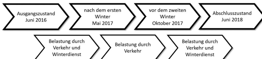
Abbildung 5-4: Prüfplan zur Überwachung des Leuchtdichteverlaufs
