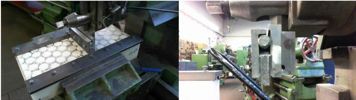
Abbildung 3-9 Schürfleiste im System (li) und Nahaufnahme der eingespannten Schürfleiste (re)
