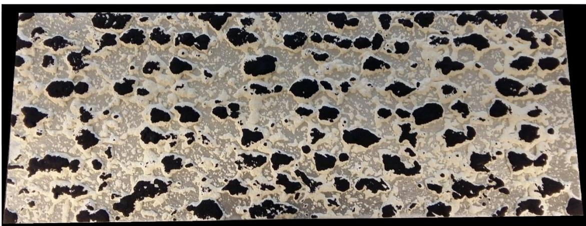
Abbildung 4-6 geschwärtzter Probekörper mit stochastischer Agglomeratmarkierung
