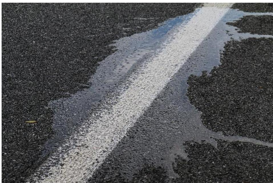
Abbildung 5-5 Durchführung einer Nassmessung auf trockener Fahrbahn
