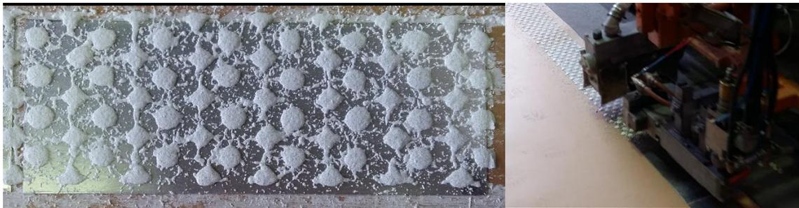
**Abbildung 3-2 Markierungsmaschine (rechts) und markierte Prüfplatte (links)**
