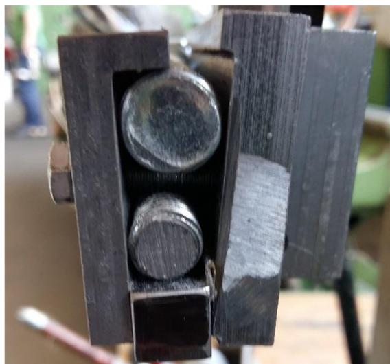
Abbildung 3-8 Seitenansicht der Schürfleiste (Vorversuchsreihe)
