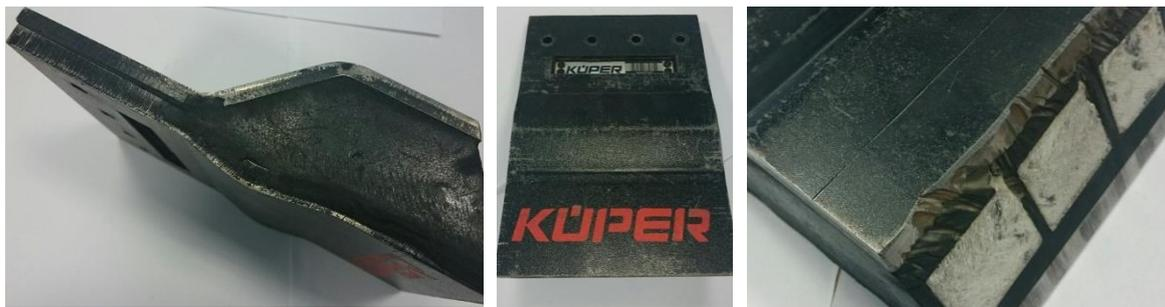
Abbildung 3-7: KÜPER Wave S 50 Schürfleiste im Labormaßstab
