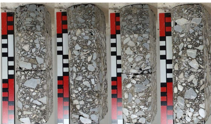
ABB 1. Fotos der Bohrkerne des Beispiel-Projekts (A4)
