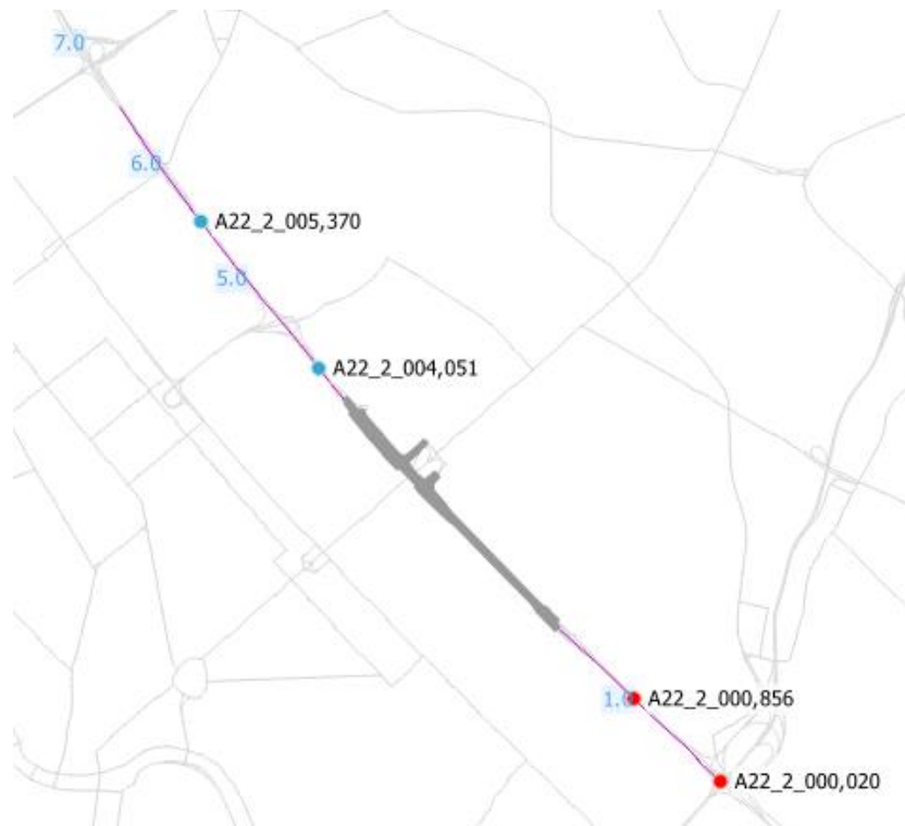
Abbildung 39: Umgebungskarte der A22 beim Kaisermühlentunnel mit Verkehrssensoren (blau: vor Stau, rot: im Stau, gelb: stockender Verkehr, grün: nach Stau)
