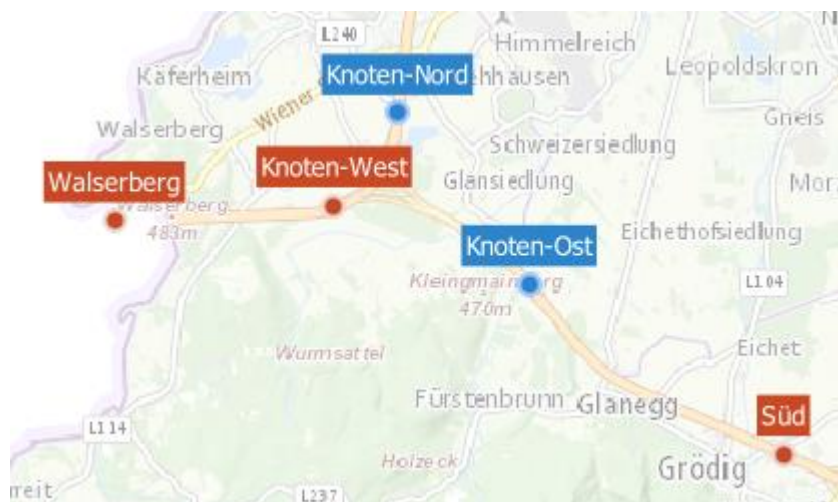
Abbildung 53: Handlungsempfehlung zur Installation von zwei weiteren Bluetooth-Sensoren (blau) als Ergänzung der bestehenden Sensorik (braun) am Knoten Salzburg
