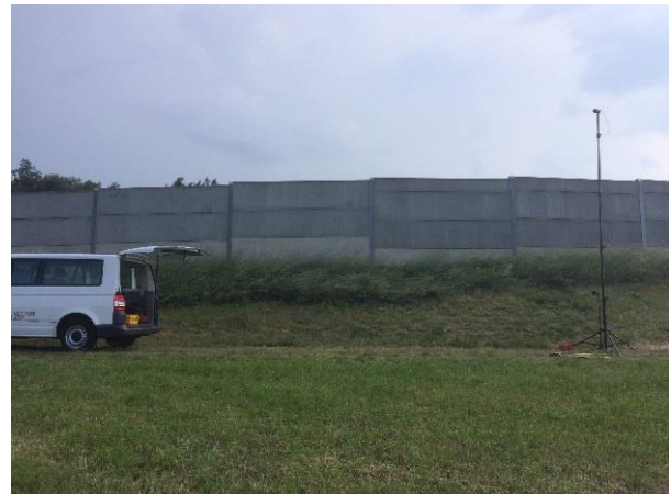
Abbildung 28: Straßenseitige Mikrofonposition und Ferfeldmikrofonposition von Querschnitt C (oben); Absicherung der Betriebsausfahrt mit einem Kabelkanal (links unten); Straßenseitige Mikrofonposition von Querschnitt D (rechts unten)
