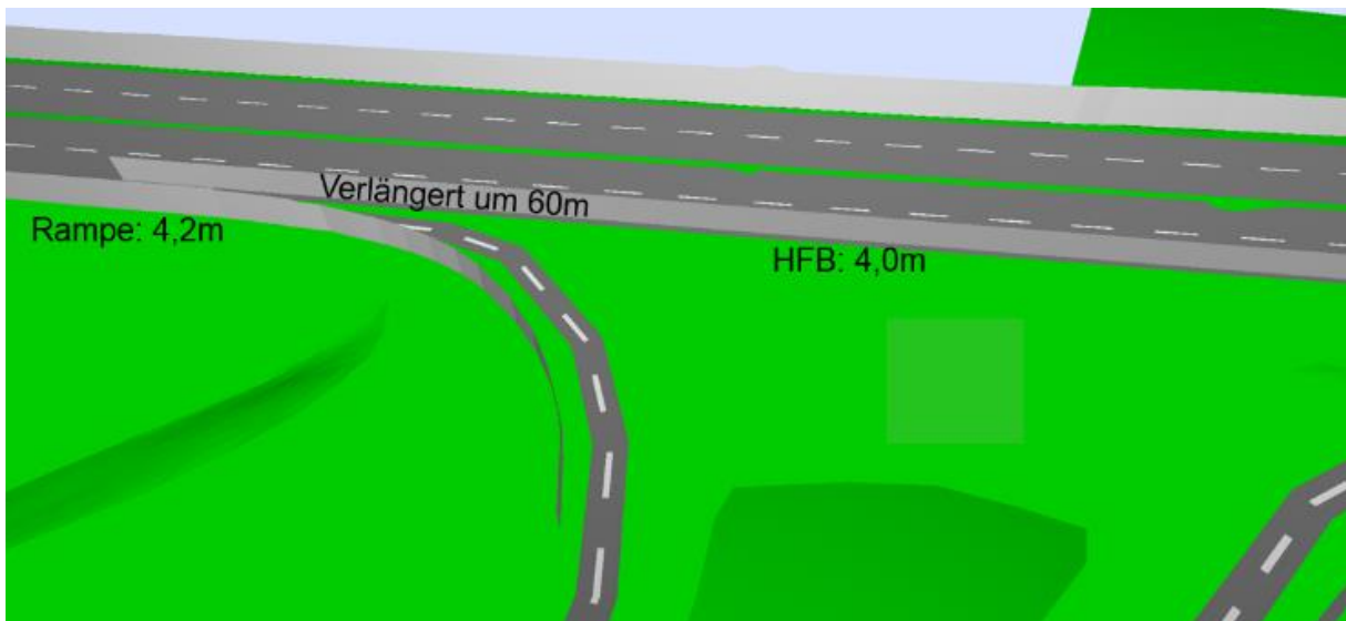
Abbildung 51: Variante 4 – Verlängerte Lärmschutzwand an HFB
