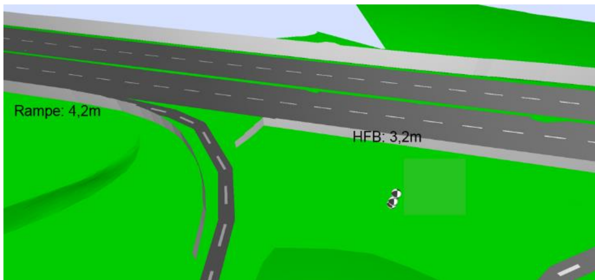
Abbildung 54: Variante 7 – Aufsteigend angewinkelte Lärmschutzwand an HFB
