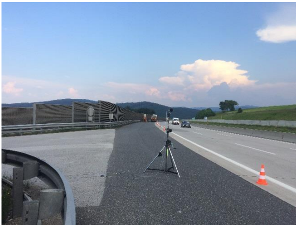
Abbildung 28: Straßenseitige Mikrofonposition und Ferfeldmikrofonposition von Querschnitt C (oben); Absicherung der Betriebsausfahrt mit einem Kabelkanal (links unten); Straßenseitige Mikrofonposition von Querschnitt D (rechts unten)
