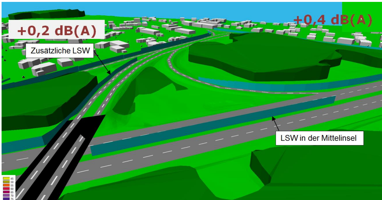
Abbildung 84: Beispielstandort Baden - Lärmschutzwand im Mittelstreifen
