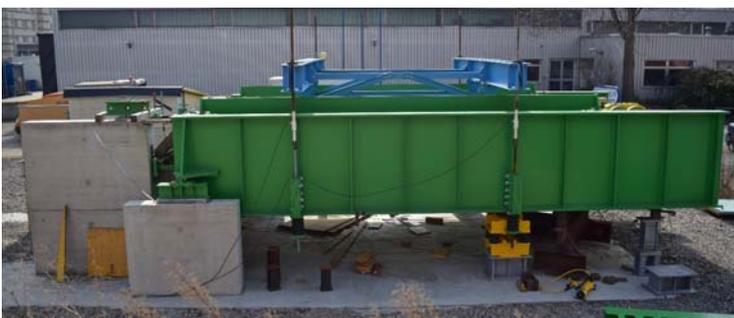
**ABB 1. Ansicht der Großversuchsanlage mit der Anlagenerweiterung (Vorspannvorrichtung – blaue Konstruktion) zur Simulation der Auflast aus überfahrenden Radsätzen**
