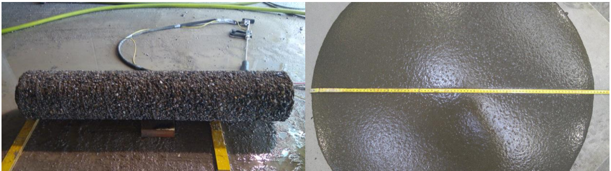
Abbildung 6.23: Herstellung der Probekörper aus Normalbeton
