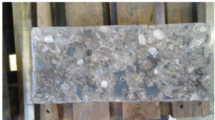
Abbildung 5.8: Beispiel für den Bruch in der Fuge/Aufbetonschicht der Probe HS-FEIN-35-3
