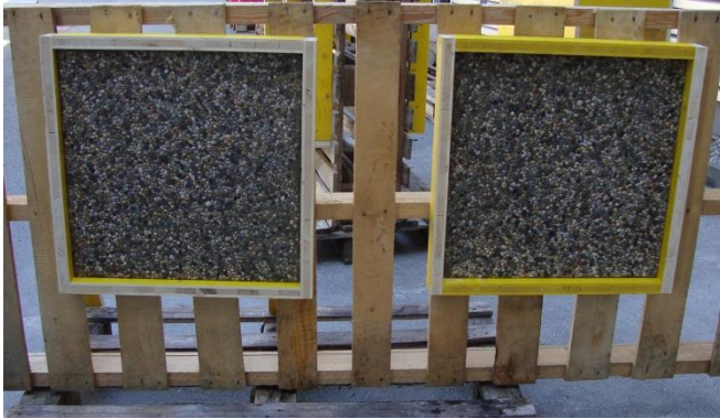
Abbildung 4.2: Sprühstände aus alten Paletten und Waschbetonplatten mit Rahmen
