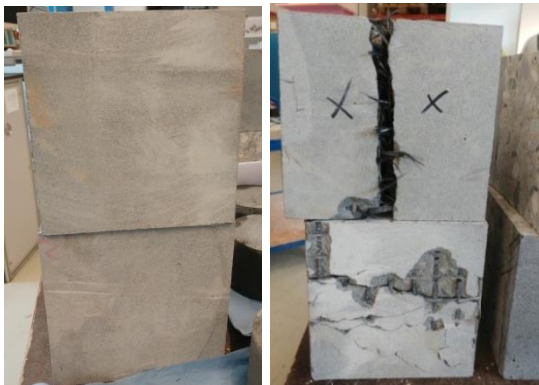
Abbildung 4.9: Intakte, ungerissene sowie durchgerissene Probekörper nach der Biegezugprüfung
