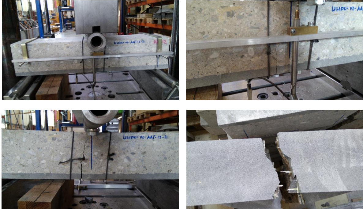
Abbildung 3.5: Versagen des Balkens UHPC-VL-AAE-12-2 (Garnbruch)
