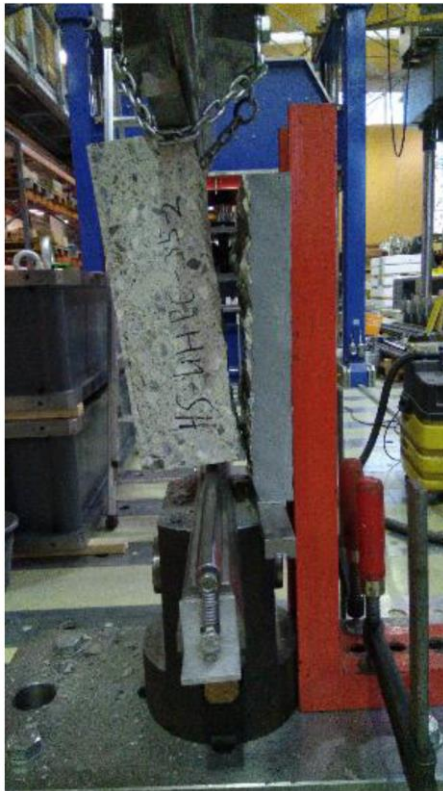
Abbildung 5.7: Beispiel für den Bruch in der Fuge der Probe HS-UHPC-35-2
