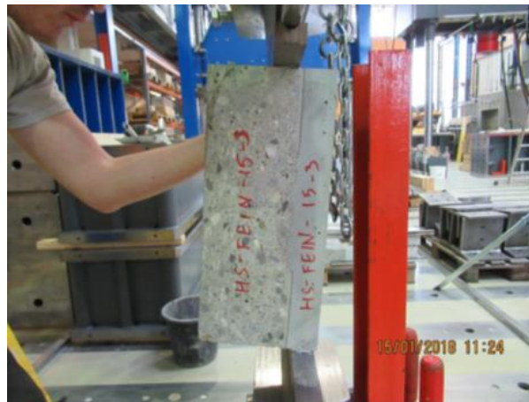
Abbildung 5.6: Skizze und Durchführung der Haftscherversuche
