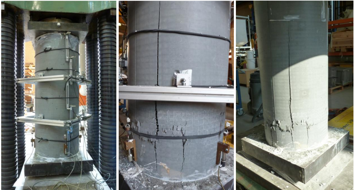
Abbildung 6.27: Anordnung der Messinstrumente und Versagensbilder für Normalbetonstütze (oben) und verstärkte Stütze (unten) der zweiten Versuchsserie
