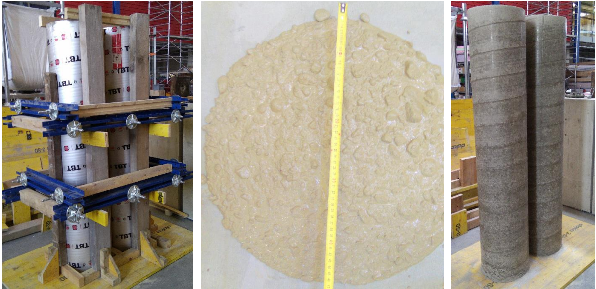
Abbildung 6.23: Herstellung der Probekörper aus Normalbeton
