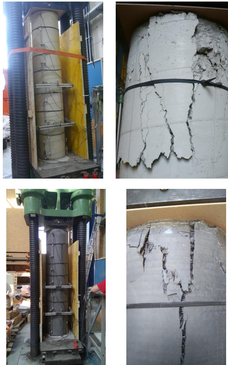
Abbildung 6.25: Anordnung der Messinstrumente und Versagensbilder der für Normalbetonstütze (oben) und verstärkte Stütze (unten)
