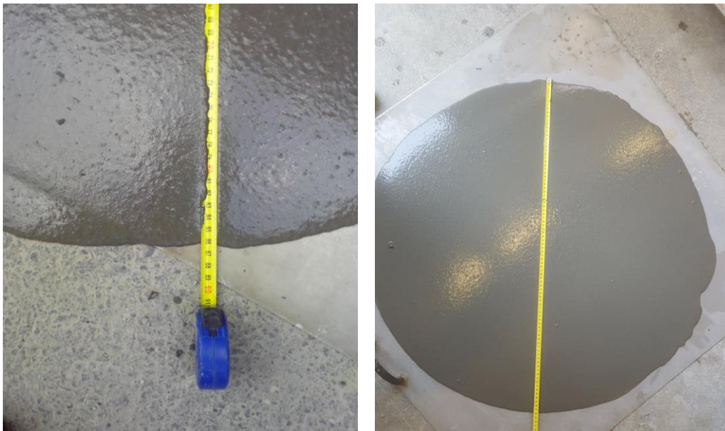
Abbildung 3.3: Setzfließmaß des frischen UHPC
