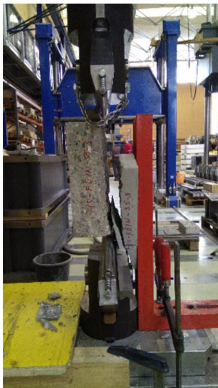
Abbildung 5.8: Beispiel für den Bruch in der Fuge/Aufbetonschicht der Probe HS-FEIN-35-3
