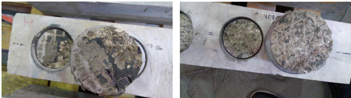
Abbildung 5.3: Versagensbereiche der Haftzugversuche bei Verwendung von Feinbeton mit Carbon+EP (links) und mit Carbon+SBR (rechts)
