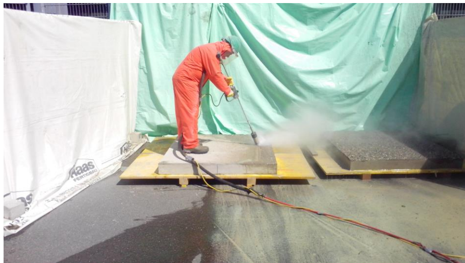
Abbildung 3.2. HDW-Strahlung der Probekörper
