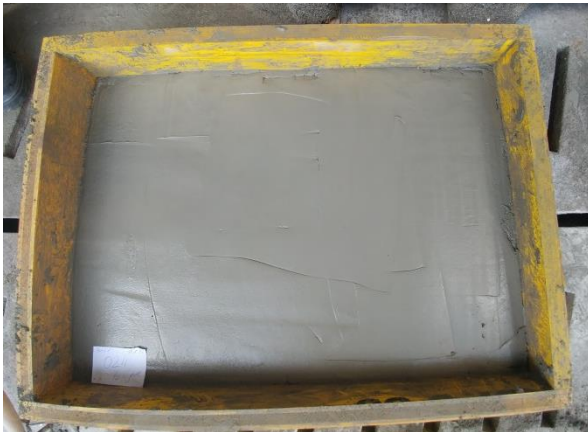
Abbildung 4.10: Gesprühte Platte aus Feinbeton in Kiste
