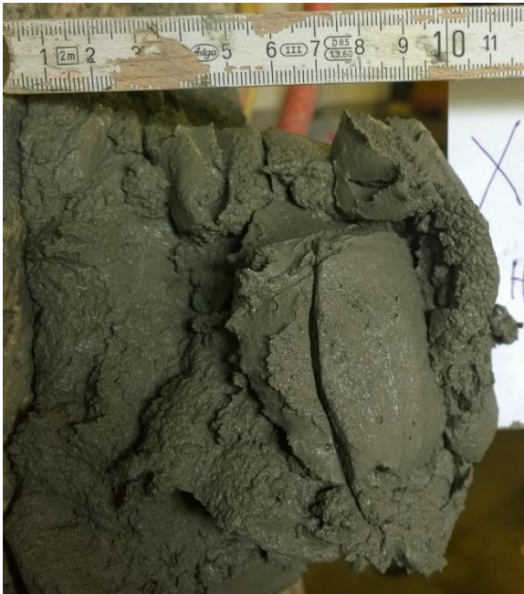
Abbildung 2.1: Kriterium Klebrigkeit/Haftung an einer senkrechtstehenden rauen und vorgehässeten Oberfläche
