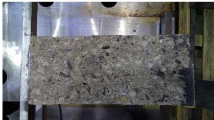
Abbildung 5.7: Beispiel für den Bruch in der Fuge der Probe HS-UHPC-35-2
