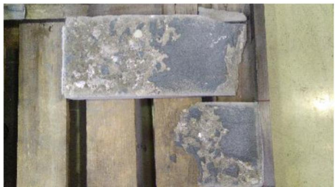
Abbildung 5.7: Beispiel für den Bruch in der Fuge der Probe HS-UHPC-35-2
