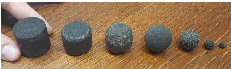
ABB 1. Unterschiedliche Schüttelabriebe verschiedener Gesteine.
