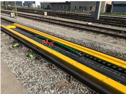
Der Entkuppler beruht auf einer zwischen den Schienen eingebauten Konstruktion mit sehr geringer Bauhöhe. Mit einer auf dem Kniehebelprinzip basierenden Mechanik wird eine speziell gestaltete Kontaktplatte auf Zuggeschwindigkeit beschleunigt und angehoben, sodass der Kupplungsbügel aus dem Kupplungshaken gehoben werden kann. Das Bild zeigt den im Vbf Linz installierten Demonstrator.
