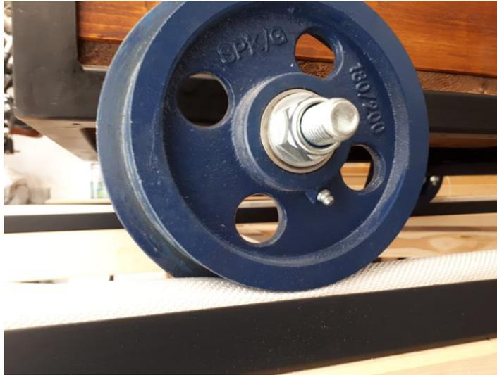
Abbildung 48: Abrollversuche bei 4 bar Schlauchdruck (Rad wird angehoben)
