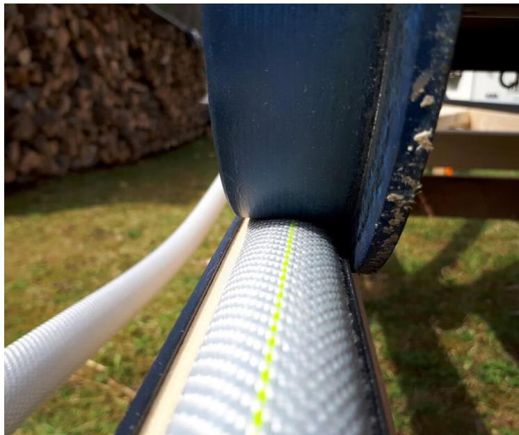
Abbildung 61: Rad-Schlauch-Schienenkontakt am Bremssystem
