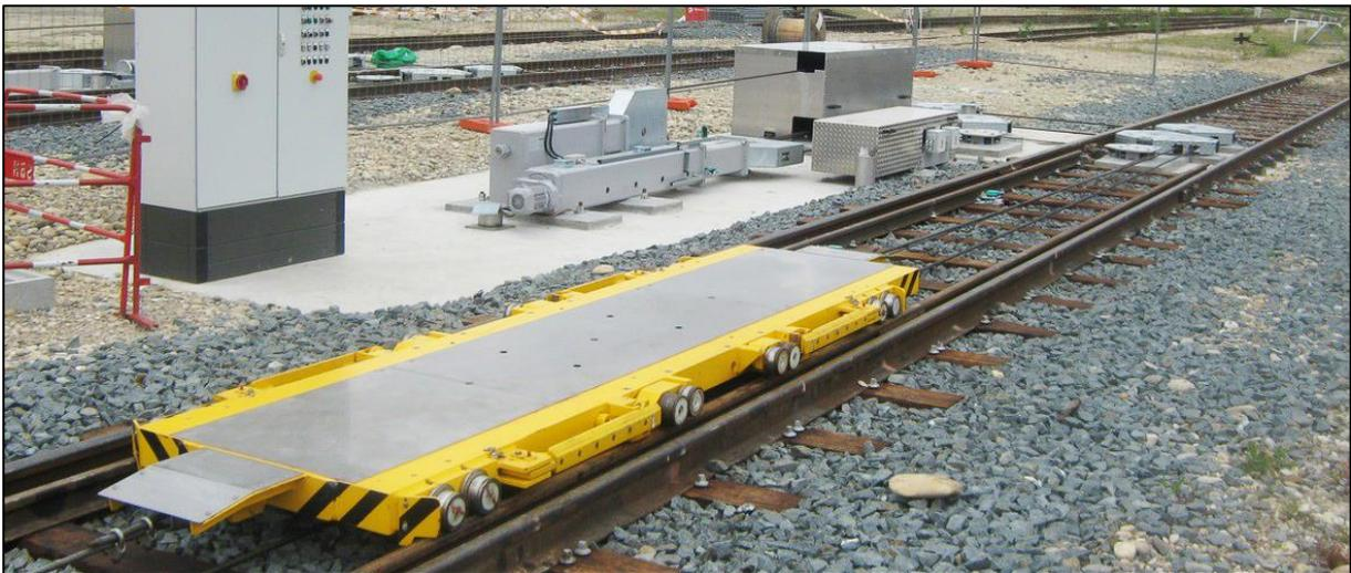
Abbildung 76: Radsatzschubwagen der Firma Vollert<sup>49</sup>
