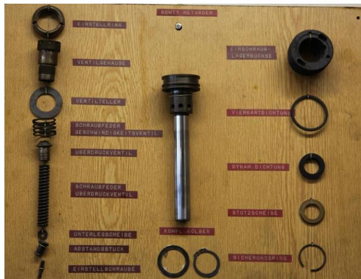
**Abbildung 86: Einzelbauteile Gleitzylinder<sup>76</sup>**
