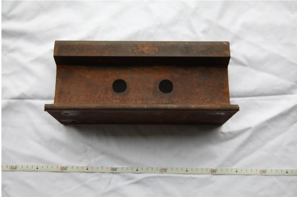
**Abbildung 108: UIC - 49E1 Demonstratorschienenstück<sup>151</sup>**
