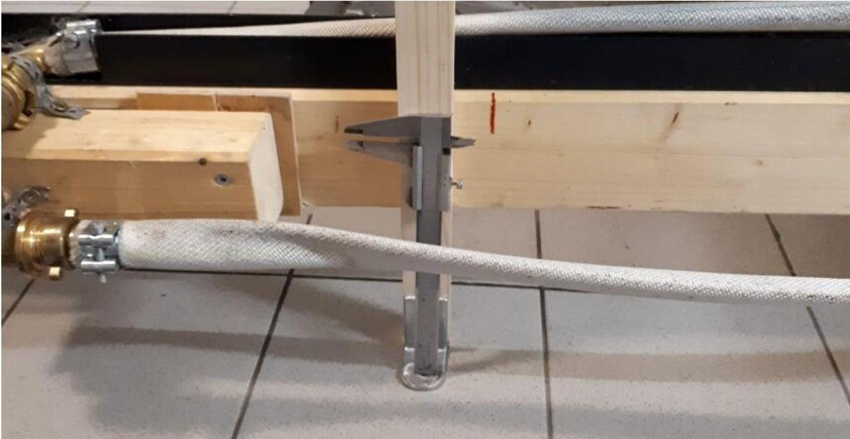
Abbildung 50: Messung der Rampenneigung mittels Messschieber
