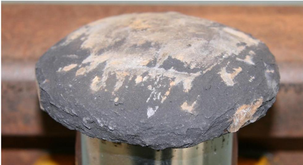
**Abbildung 122: Retarderhaube nach 200 Schlägen mit einfacher Beschichtung**
