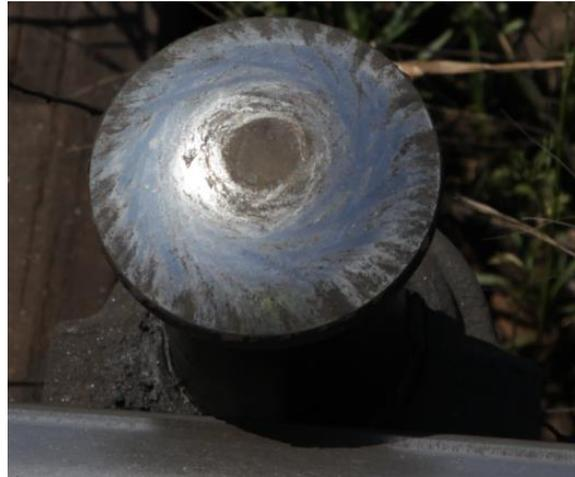
Abbildung 92: Abnutzung an der Pilzhaube<sup>92</sup>
