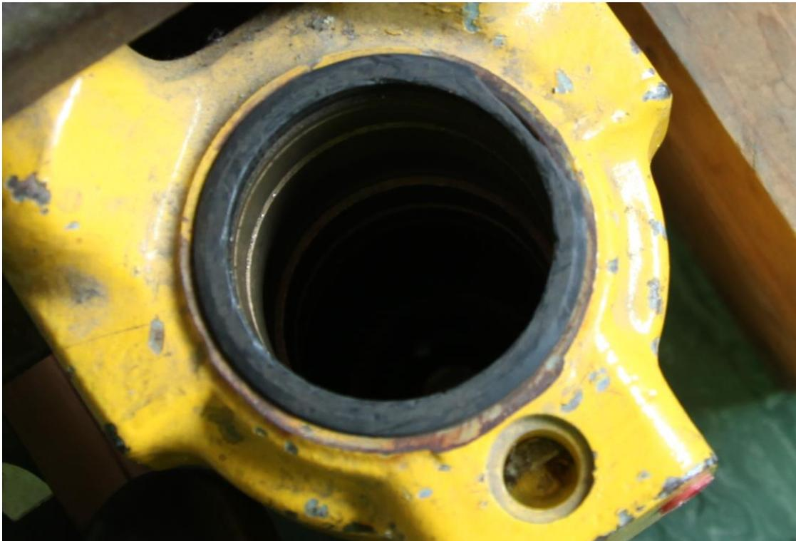
**Abbildung 103: Dowty-Retardergehäuse mit Vierkantdichtung<sup>137</sup>**
