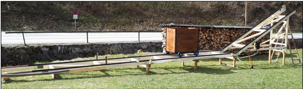
**Abbildung 1: Demonstrator Variabler Rollwiderstand**
