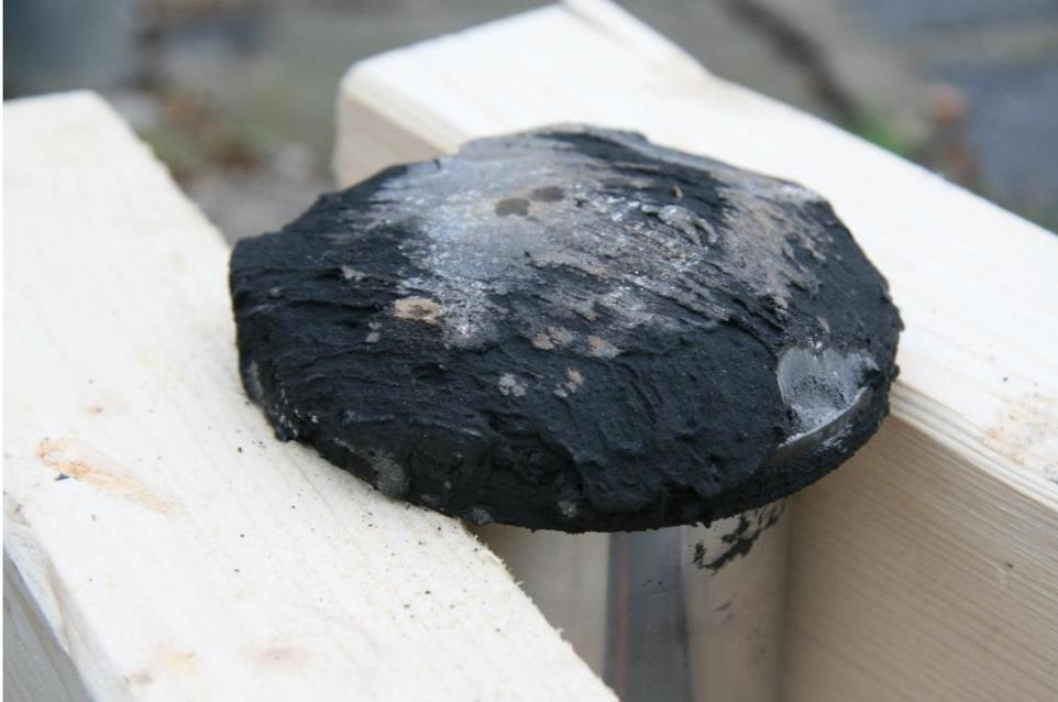
**Abbildung 123: Retarderhaube nach 50 Schlägen mit dreifacher Beschichtung<sup>181</sup>**
