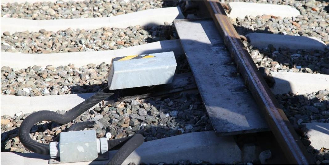
**Abbildung 106: Einrichtung zur Spurkranzschmierung<sup>146</sup>**
