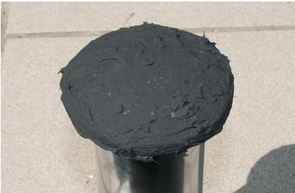
Abbildung 113: Beschichtete Haube einer Retarderkapsel<sup>161</sup>
