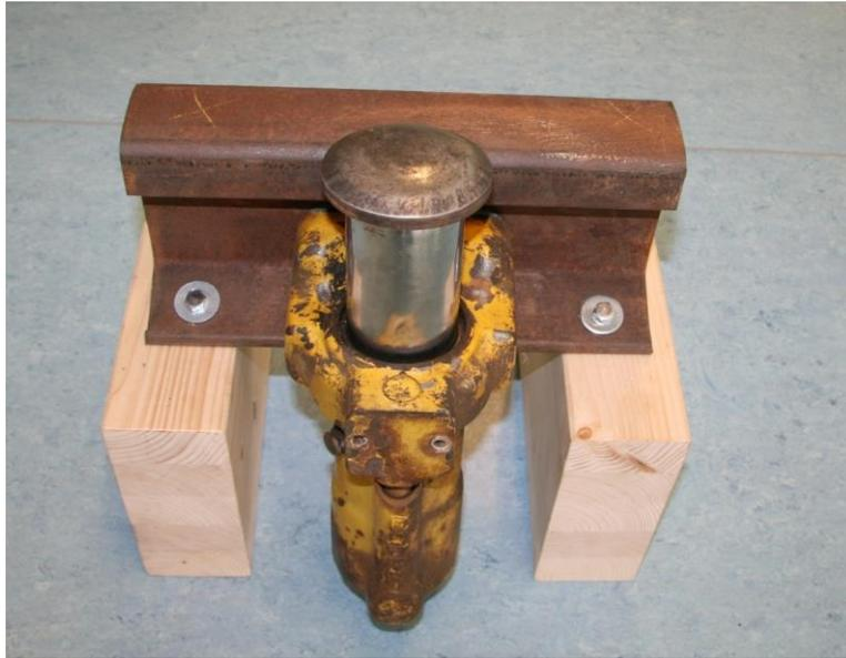
Abbildung 82: Demonstrator mit Gehäuse und Gleitzylinder<sup>67</sup>
