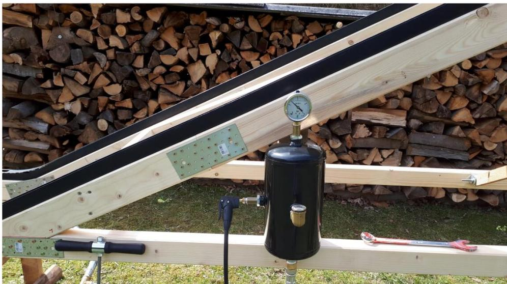
Abbildung 59: Druckausgleichsbehälter mit Ventil zur Bremsdrucksteuerung, montiert an der Ablauframpe
