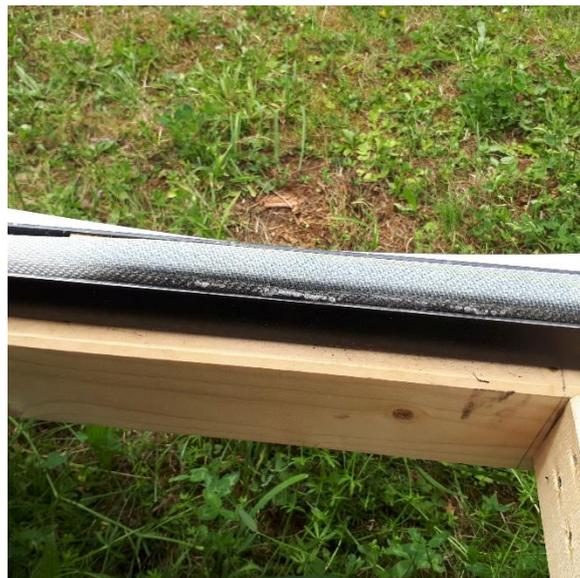
**Abbildung 64: Verschleißerscheinungen am Flachschauch**
