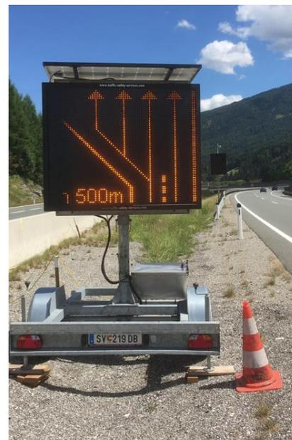
**Abbildung 22 Anzeigetafel an der A10 zur Verteilung des Verkehrs. Laut Erfahrungswerten der ASFINAG befolgen ca. 10-15% der Lenker diese Hinweise (Bildquelle: ASFINAG)**
