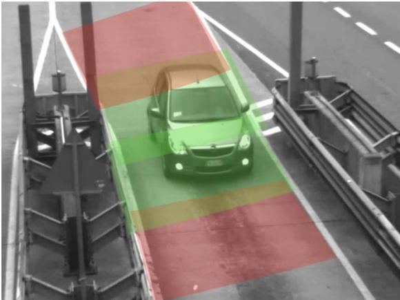
**Abbildung 15: Die Belegungsdetektion erfolgt durch die Klassifikation von ca. 1m langen Messfeldern entlang jeder Fahrspur in ‚belegt‘ bzw. ‚frei‘.**
