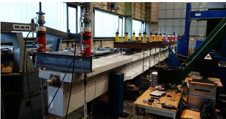
ABB 1. Großmaßstäbliche Belastungsversuche zur Untersuchung der Querkrafttragfähigkeit von mehrfeldrigen Spannbetonbrücken
