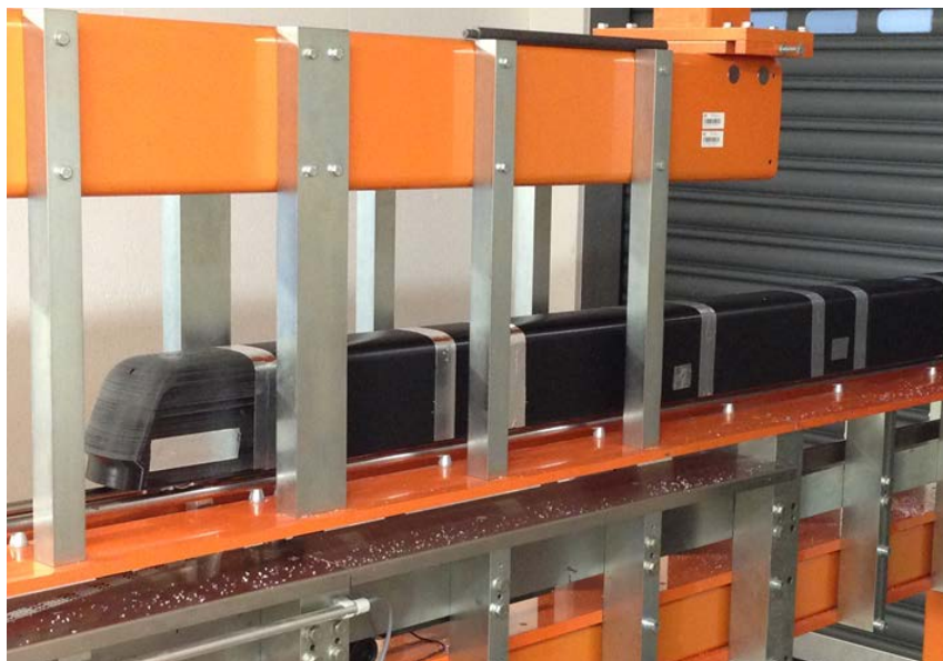
ABB 2. Modellzug Rail Jet v_{\max}=230 km/h in der Tunnelsimulationsanlage
