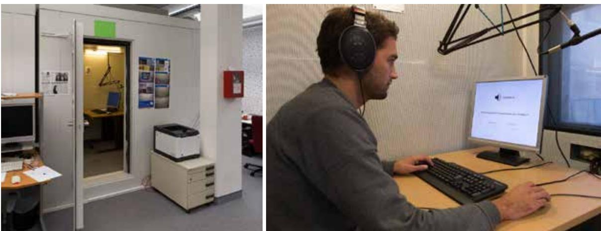
Abb. 6-2: Wahrnehmungstests - Schallkammer des Projektpartners ISF (links) und Symbolfoto eines Probanden während der Testdurchführung (rechts)
