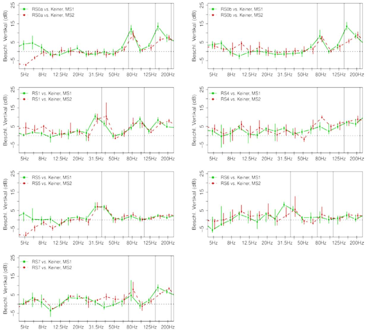
**Abb. 7-65: Spektrale Effekte der vertikalen Beschleunigung beim LKW, Testfeld 1**
