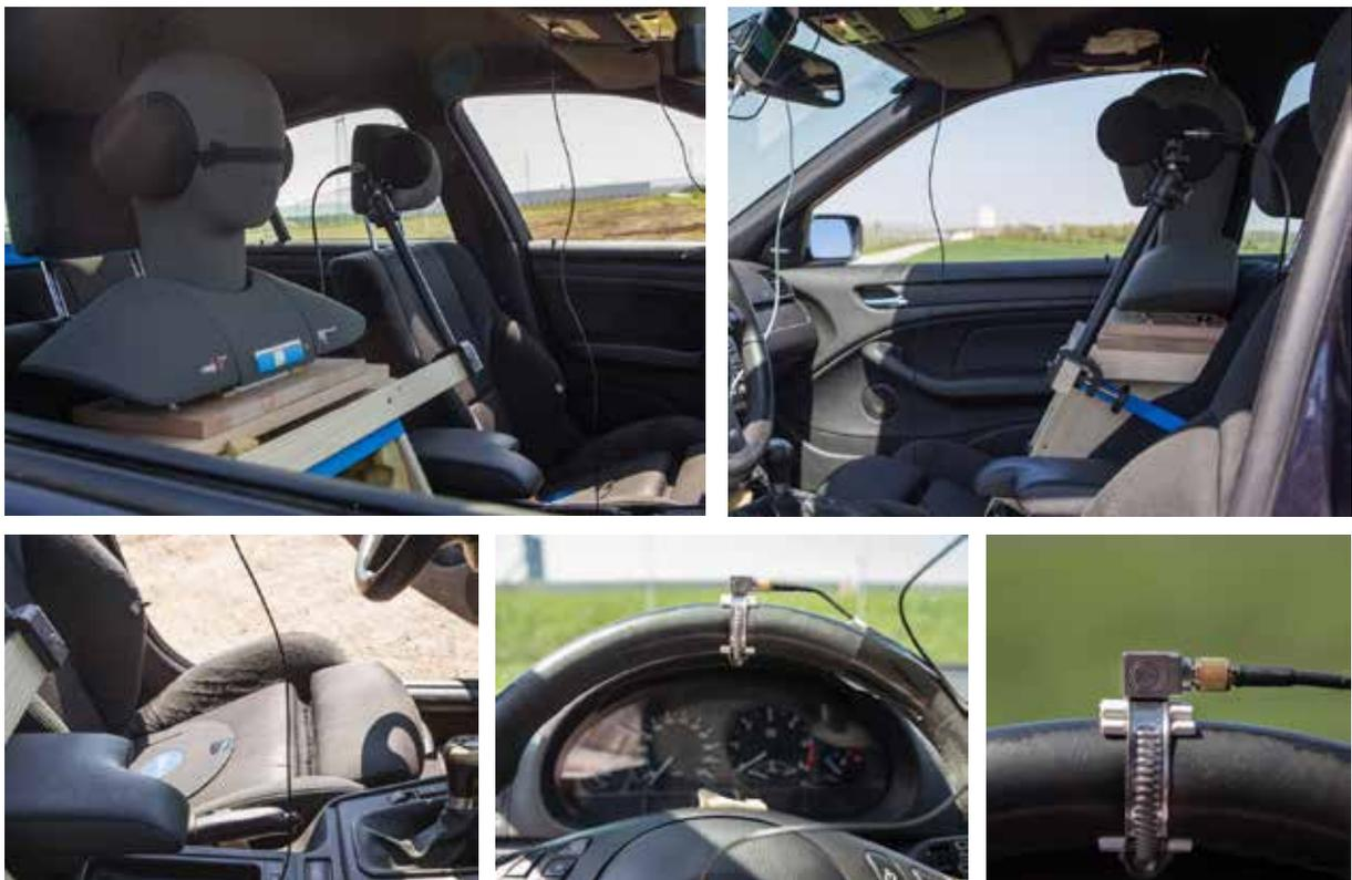
**Abb. 3-8: Messaufbau im PKW für Innenmessungen: Kunstkopfmesssystem am Beifahrersitz und in Fahrzeugmitte angeordnetes Mikrofon (oben, links und rechts), Detailansicht des 3-achsigen Ganzkörper-Sitzbeschleunigungsaufnehmers am Fahrersitz (unten, links) und Detailansichten des 3-achsigen Miniaturbeschleunigungsaufnehmers am obersten Punkt des Lenkrads (unten, Mitte und rechts)**
