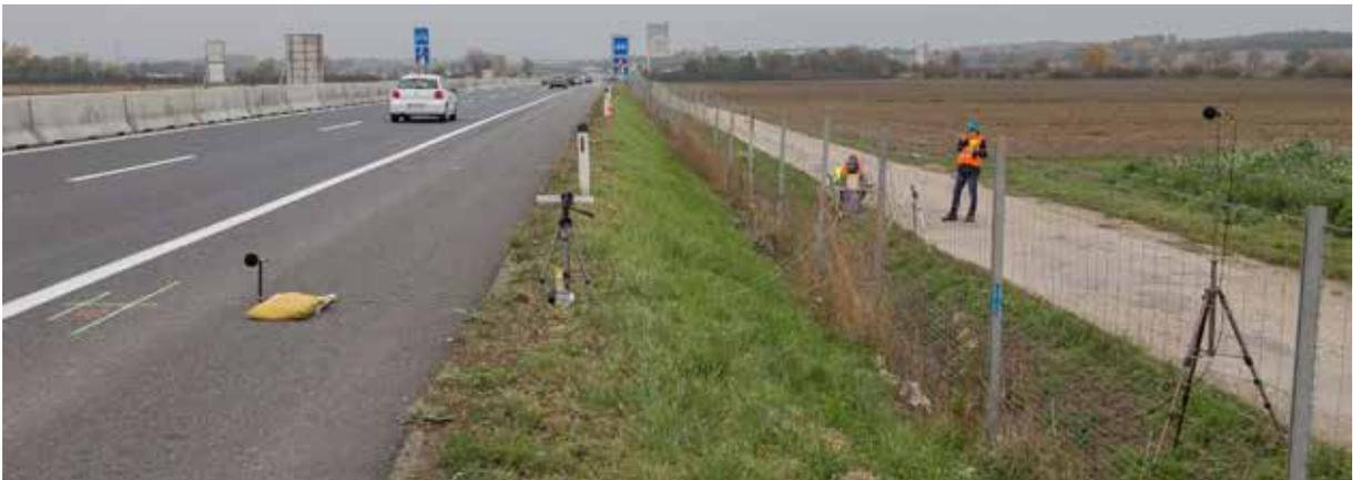
Abb. 3-5: Messaufbau zur Emissionsmessung von Einzelfugen mit 2 Mikrofonen und einer Laserlichtschranke
