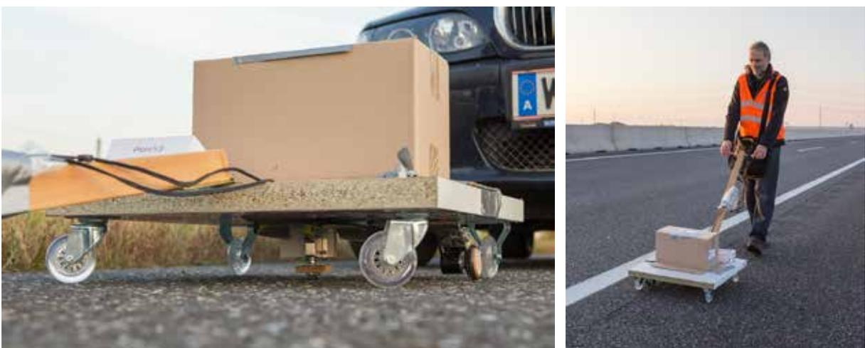
**Abb. 2-7: Messung der Rumpelstreifenprofile: Messsystem bestehend aus tastendem Wegaufnehmer zur Tiefenerfassung und Drehgeber mit Rollrad zur Messung des zurückgelegten Weg (links) und manuelle Durchführung der Messung (rechts)**
