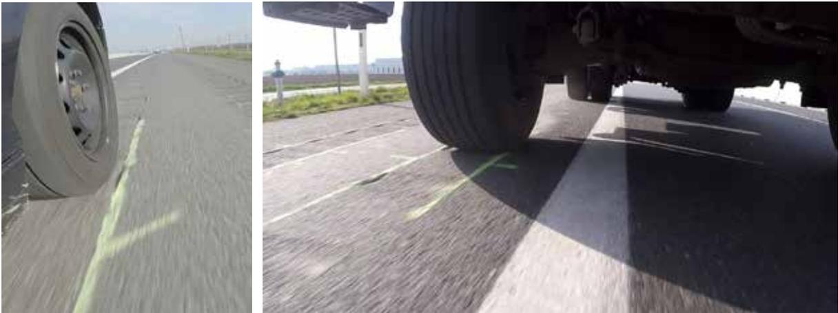
**Abb. 3-10: Exemplarische Standbilder aus den Onboard-Videoaufnahmen von Rumpelstreifenüberfahrten des PKWs (links) und des LKWs (rechts) mit sehr guter Überdeckung**
