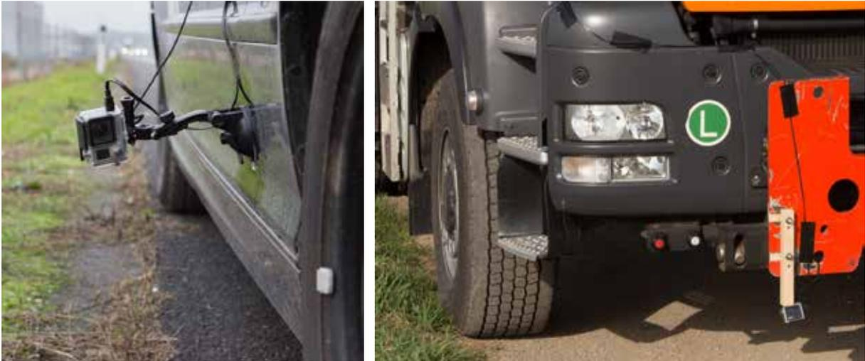
**Abb. 3-2: Videokameras zur Aufzeichnung der Einzelfugen- und Rumpelstreifenüberfahrten des rechten Vorderreifens von PKW (links) und LKW (rechts)**
