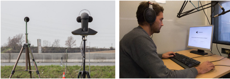
ABB 2. Binaurale Immissionsmessung und Proband bei Wahrnehmungstests
