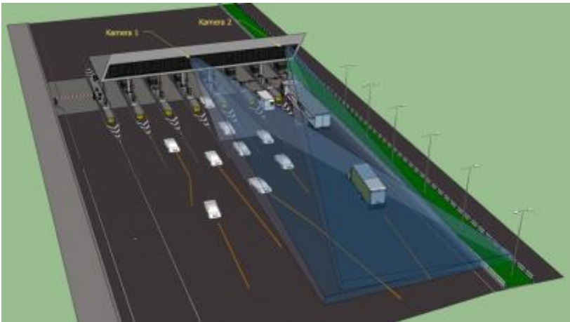
ABB 1. : Kameras beobachten das Verkehrsaufkommen an der Mautstation – daraus werden Signale für eine optimierte Umverteilung des zufließenden Verkehrs berechnet.
