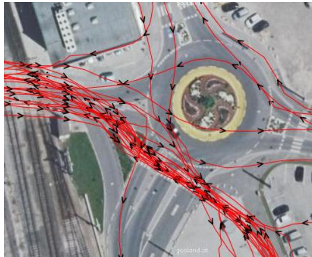
Abbildung 3: Beispiel für eine lückenhafte Fahrrad-Infrastruktur auf Basis der in den Feldtests aufgezeichneten Bewegungsdaten. Bei einem neuen Kreisverkehr verläuft der Großteil der Befahrungen über Zebrastreifen. Dieses regelwidrige Verhalten führte zu mehreren im Video dokumentierten Konfliktsituationen. Eine Ursache für diese Häufung des Fehlverhaltens könnte in der mangelnden Berücksichtigung des Radverkehrs bei der Planung des Kreisverkehrs liegen. Quelle: Prisma solutions, Salzburg Research
